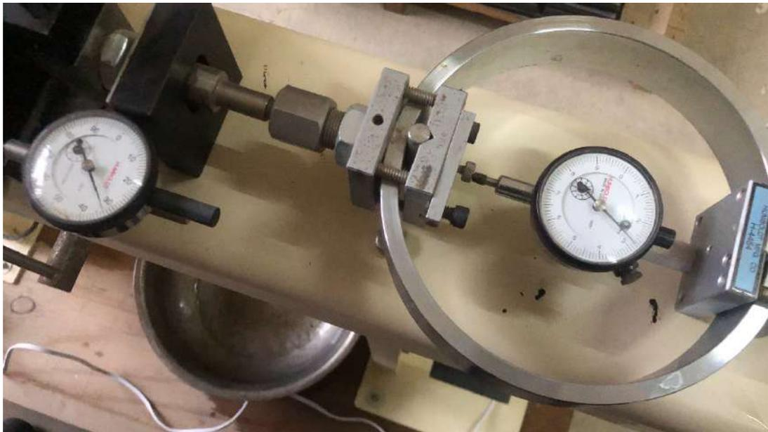
Fotografía 43. Muestra de suelo talud 1 en el molde de 5 cm<sup>2</sup>x20 a 25mm para ensayo esfuerzo de corte
