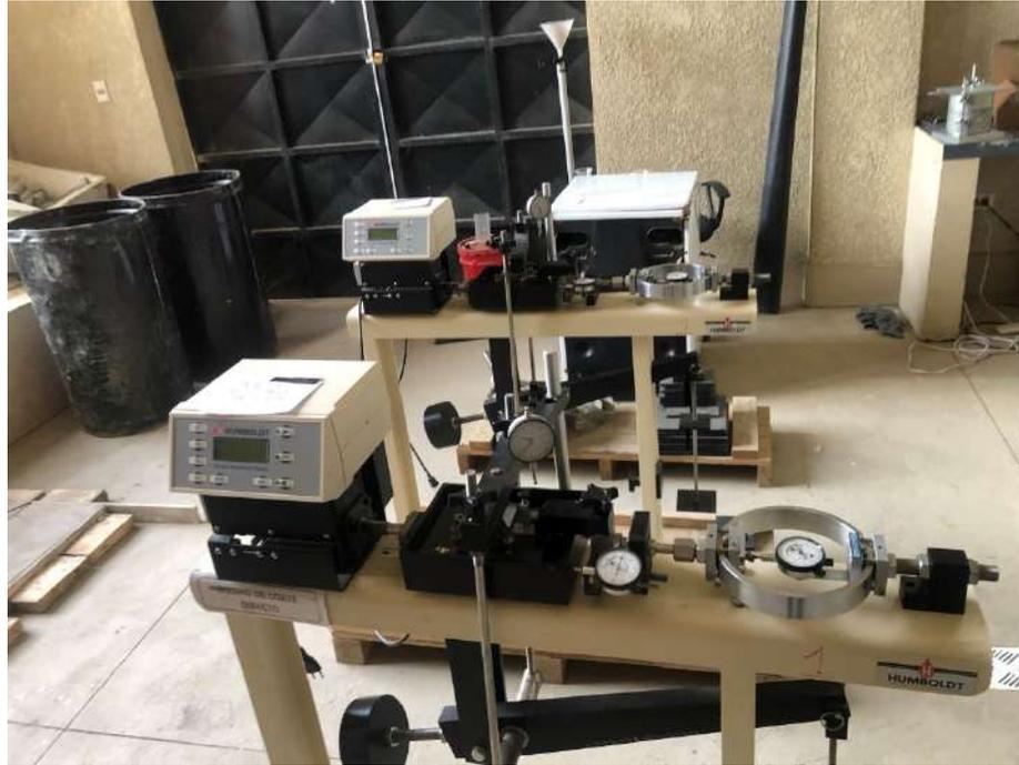
Fotografía 40. Calibración del equipo esfuerzo de corte
