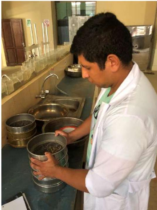
Fotografía 18. Ensayo granulométrico tamizado talud N°4
