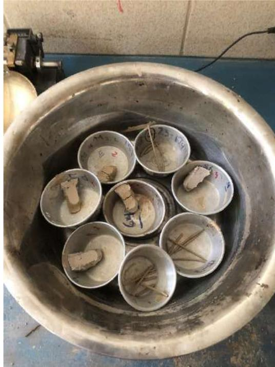
Fotografía 24. Ensayo de límites de Atterberg-plástico talud N°4
