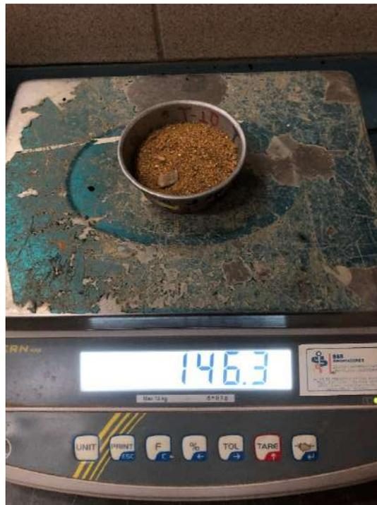
Fotografía 27. Ensayo contenido de humedad talud N°2
