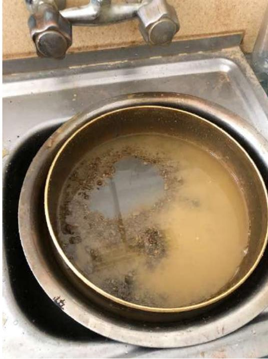
Fotografía 19. Ensayo granulométrico tamizado talud N°3
