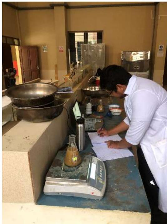
Fotografía 37. Control de temperatura ensayo peso específico
