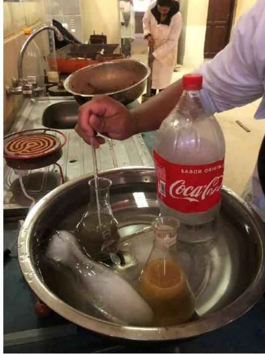
Fotografía 38. Enfriamiento del frasco volumétrico
