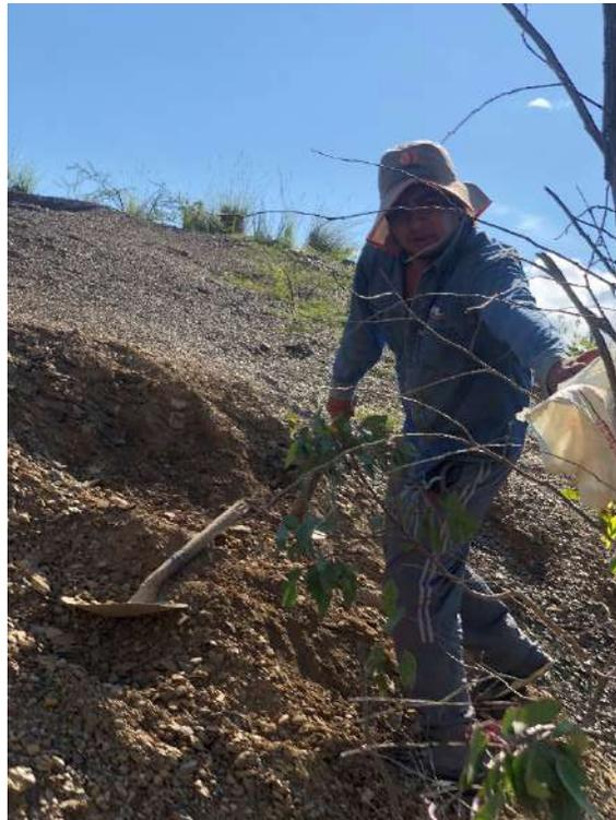
Fotografía 13. Extracción de muestra corona o cabeza del talud N°3
