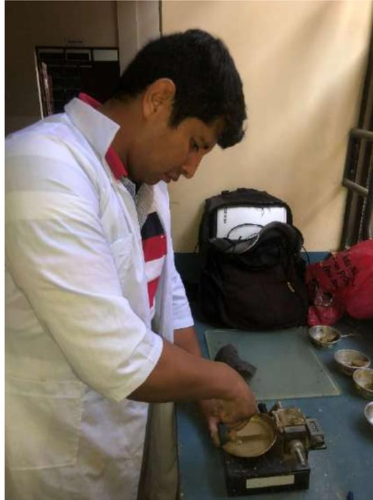
Fotografía 26. Ensayo contenido de humedad talud N°1
