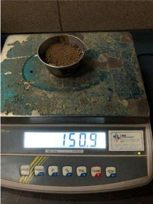
Fotografía 28. Ensayo contenido de humedad talud N°3
