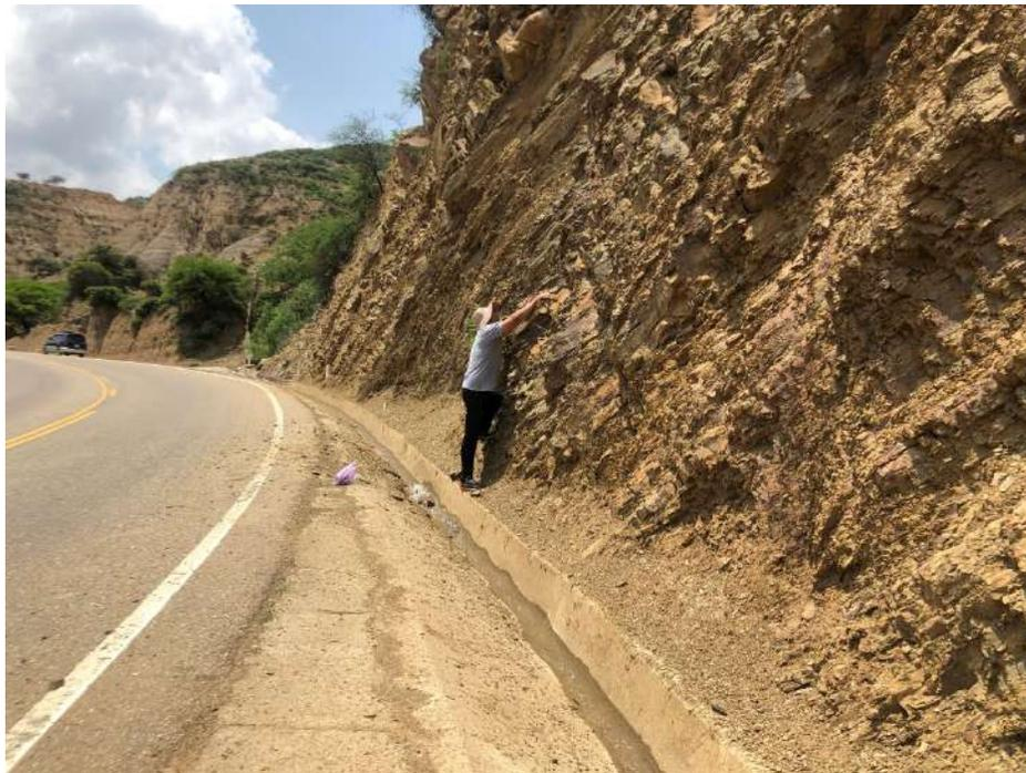
Fotografía 15. Extracción de muestra del pie del talud N°5
