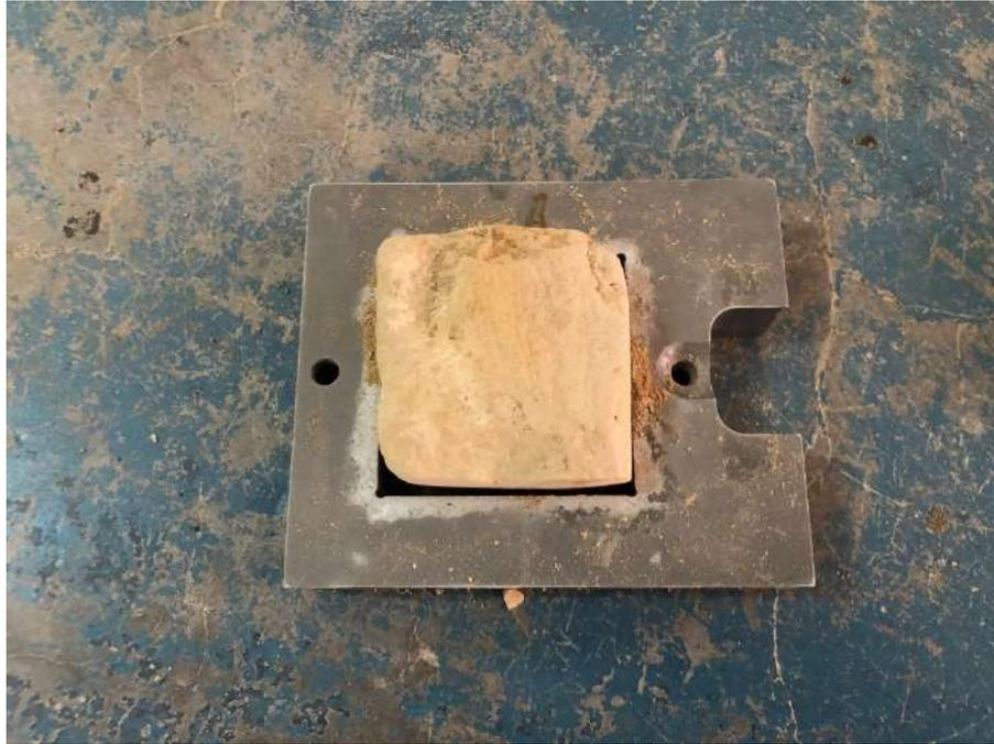
Fotografía 48. Ensayo esfuerzo de corte
