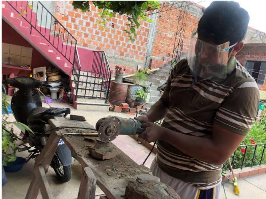
Fotografía 50. Muestras de suelos para ensayo de corte directo
