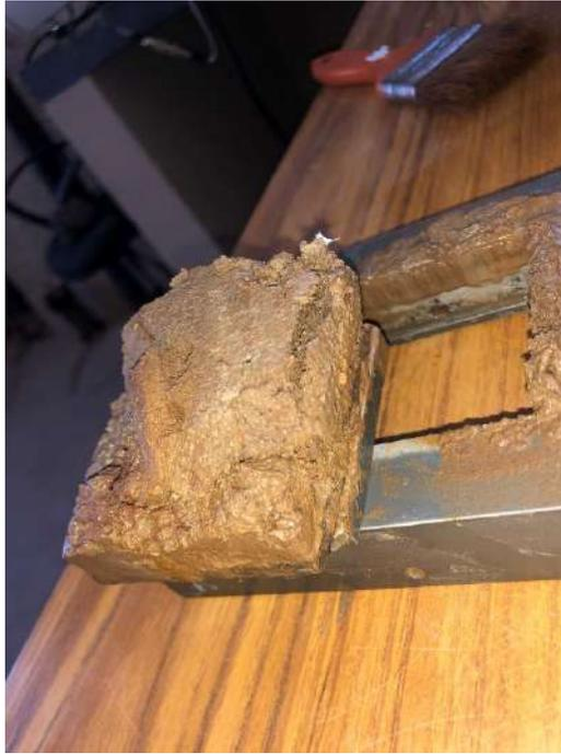
Fotografía 54. Falla de muestra ensayo corte directo
