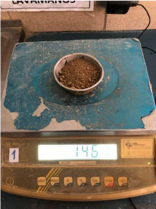
Fotografía 30. Ensayo contenido de humedad talud N°4
