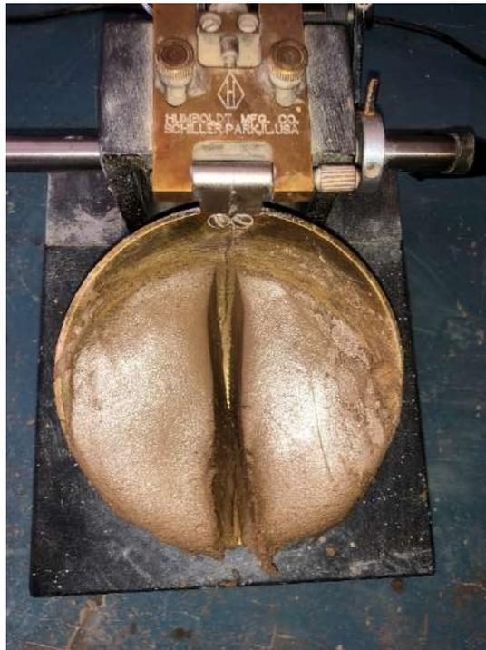
Fotografía 23. Ensayo de límites de Atterberg-líquido talud N°3
