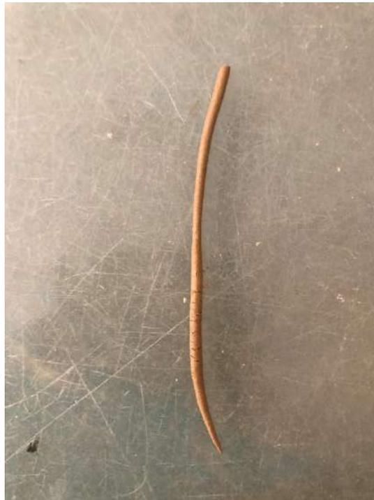
Fotografía 25. Ensayo de límites de Atterberg-líquido talud N°5
