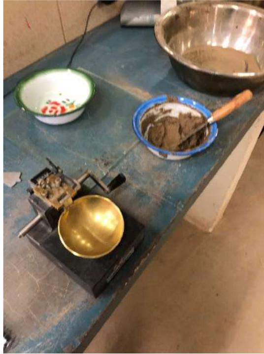
Fotografía 22. Ensayo de límites de Atterberg-líquido talud N°2
