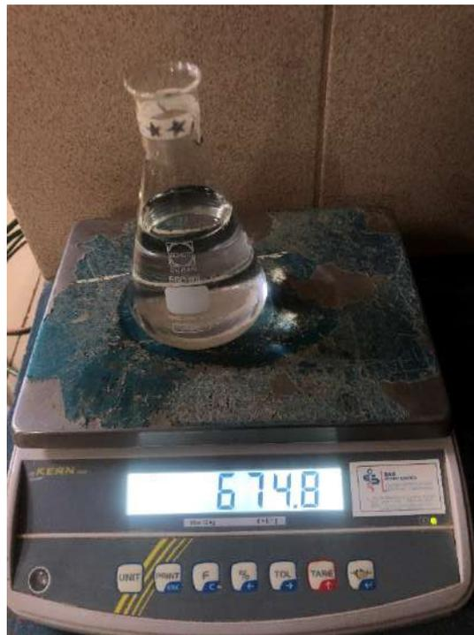
Fotografía 33. Ensayo peso específico-calibración frasco volumétrico 2
