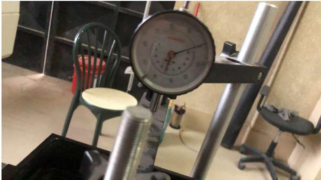
Fotografía 42. Calibración del micrómetro para deformación horizontal del equipo esfuerzo de corte
