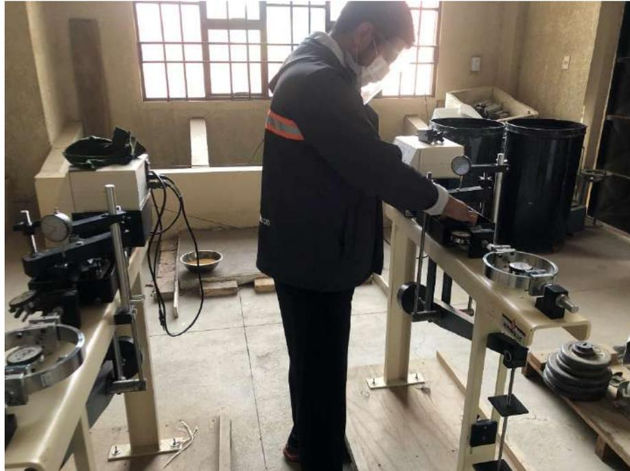
Fotografía 41. Calibración del micrómetro para deformación vertical del equipo esfuerzo de corte
