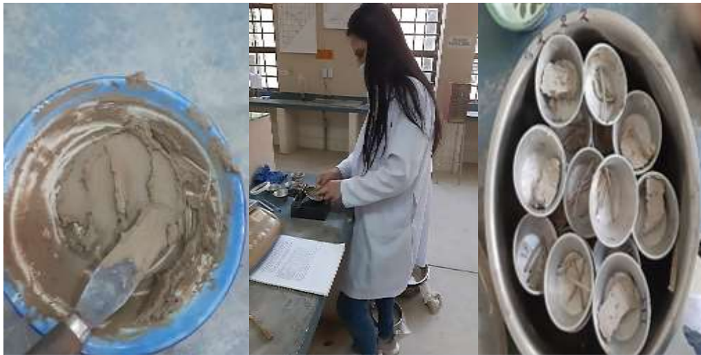
Proceso de obtención de límite líquido de las muestras de suelos
