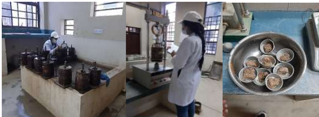
Proceso de saturación y penetración de muestras
