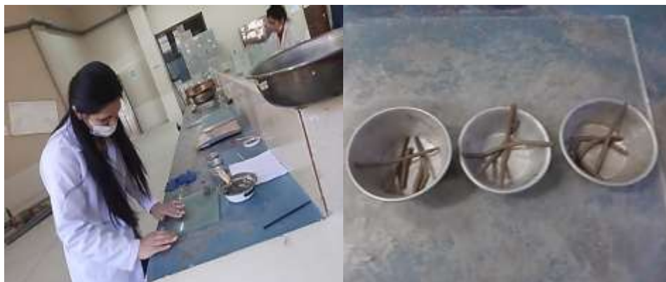
Obtención de límite plástico de las muestras de suelos.
