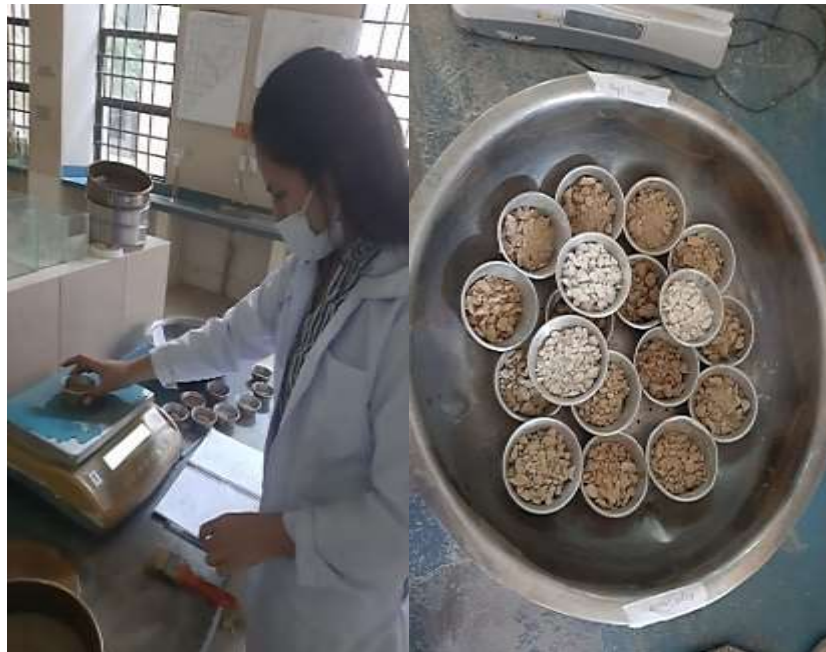
Pesado de taras y dispuestas en una fuente para ser secadas al horno.
