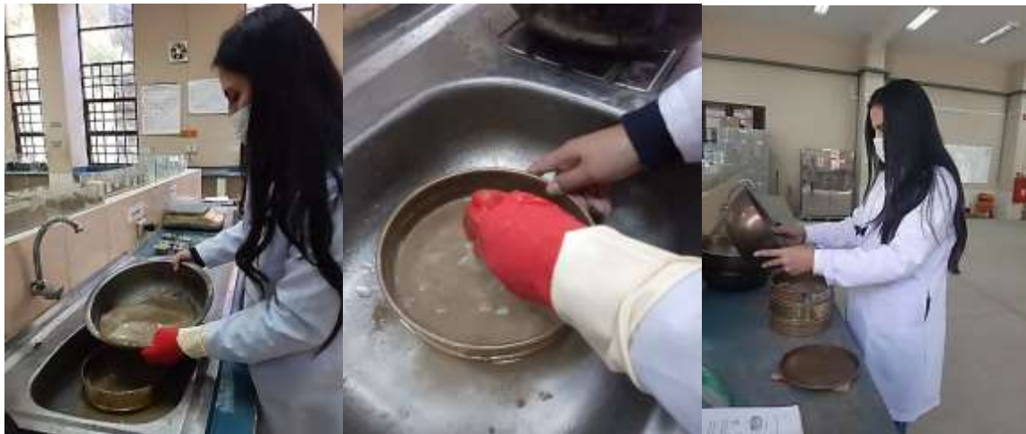
Lavado y tamizado de las muestras de suelos.
