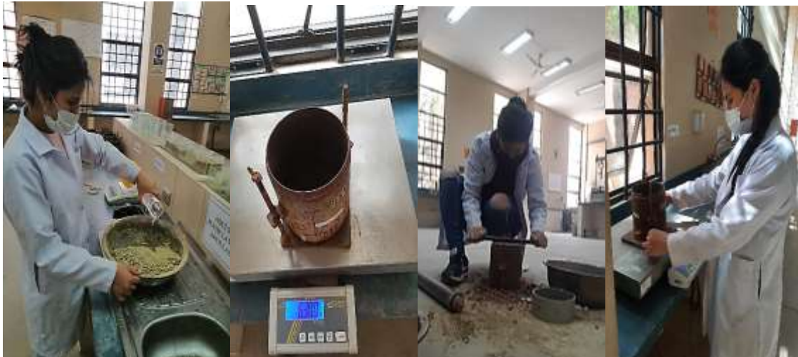
Proceso de compactación del suelo
