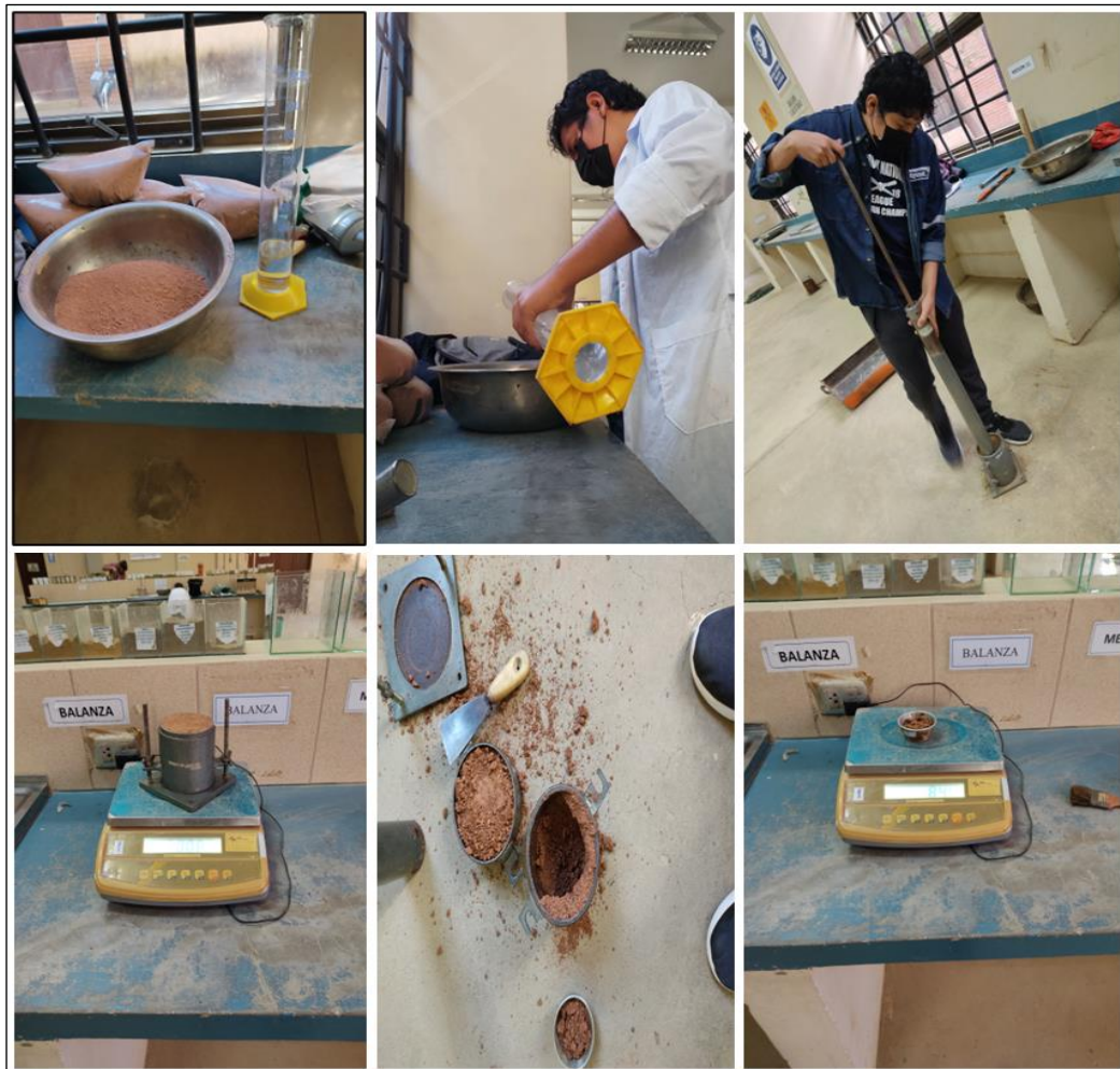
Figura 3.12 Proceso del ensayo compactación
