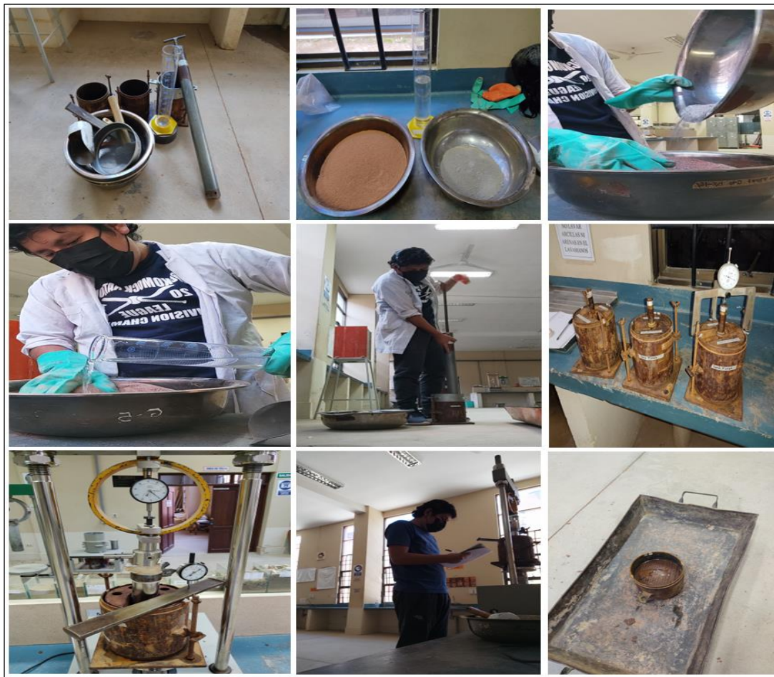
Figura 3.19 Proceso del ensayo CBR aplicando cemento
