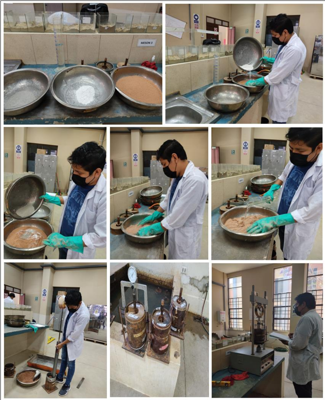
Figura 3.22 Proceso del ensayo CBR con \text{Ca(OH)}_2 y cemento
