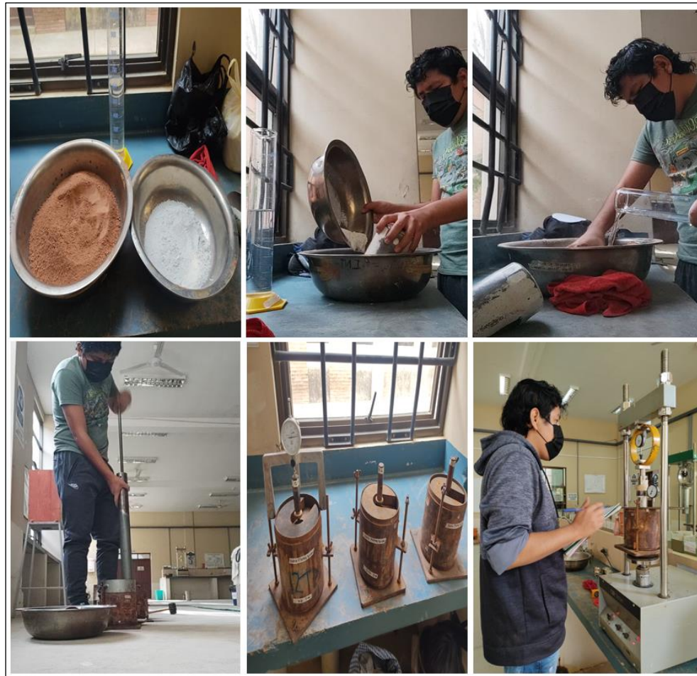
Figura 3.16 Proceso del ensayo CBR aplicando \text{Ca}(\text{OH})_2
