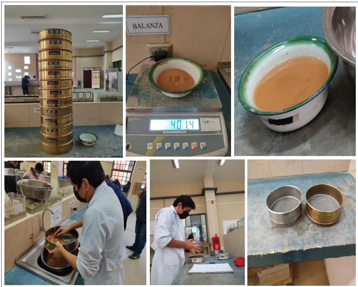
Figura 3.8 Proceso del ensayo análisis granulométrico
