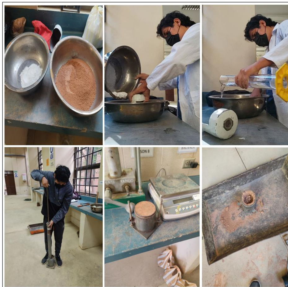
Figura 3.15 Proceso del ensayo compactación aplicando \text{Ca(OH)}_2
