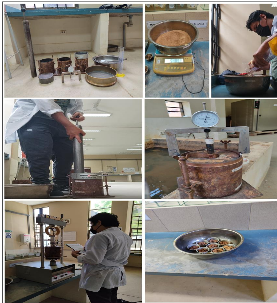
Figura 3.13 Proceso del ensayo CBR
