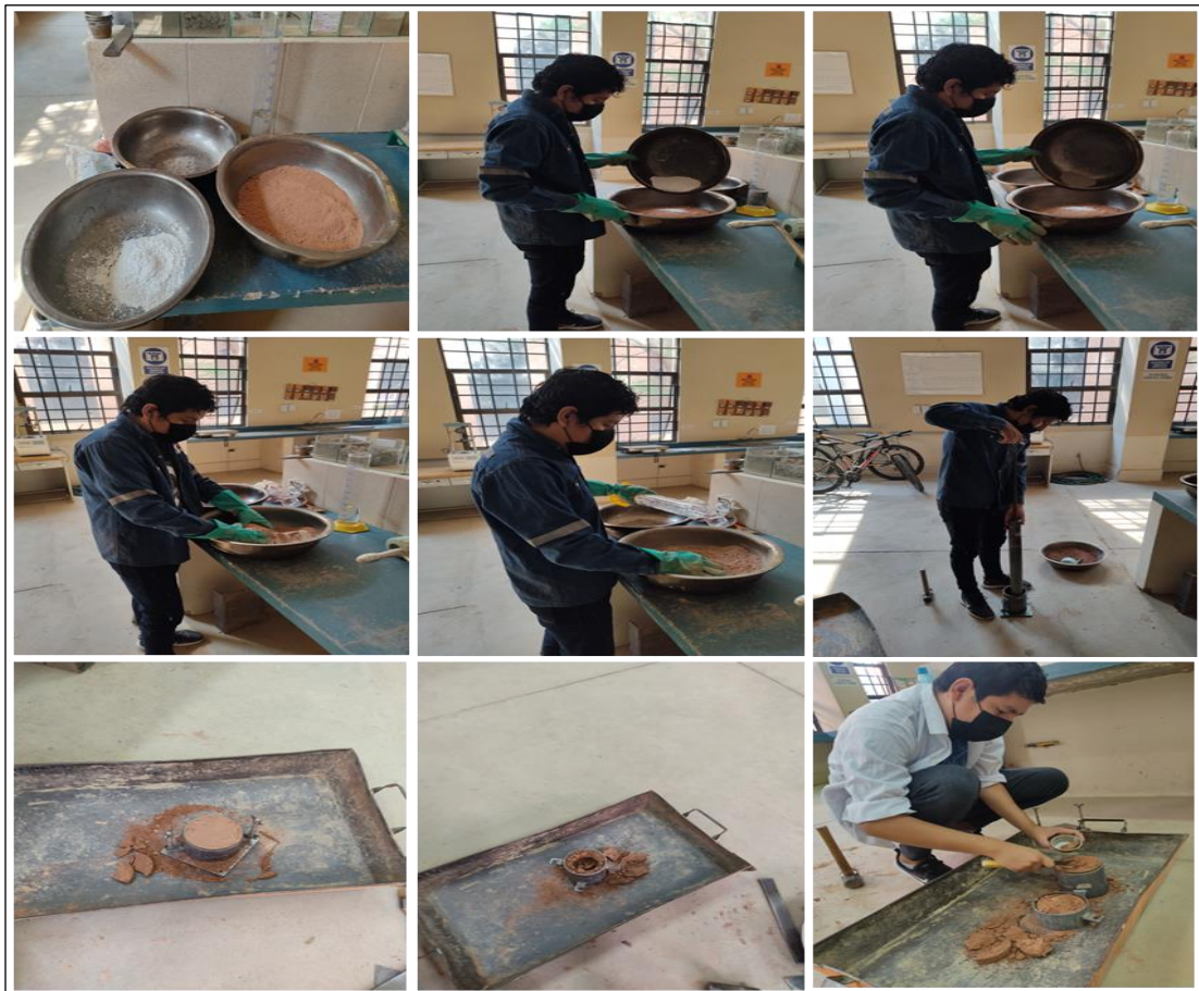
Figura 3.21 Proceso del ensayo compactación con \text{Ca(OH)}_2 y cemento
