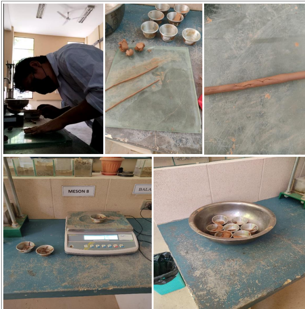
Figura 3.10 Proceso del límite plástico
