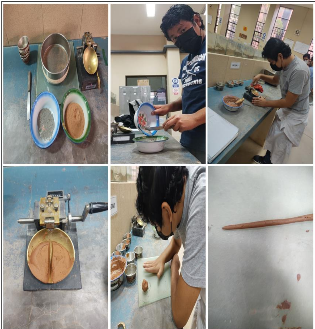
Figura 3.17 Proceso del ensayo límites de Atterberg aplicando cemento
