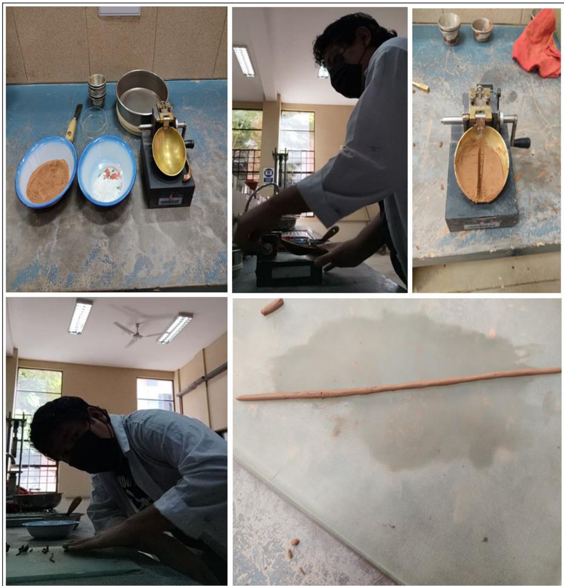
Figura 3.14 Proceso del ensayo límites de Atterberg aplicando \text{Ca}(\text{OH})_2
