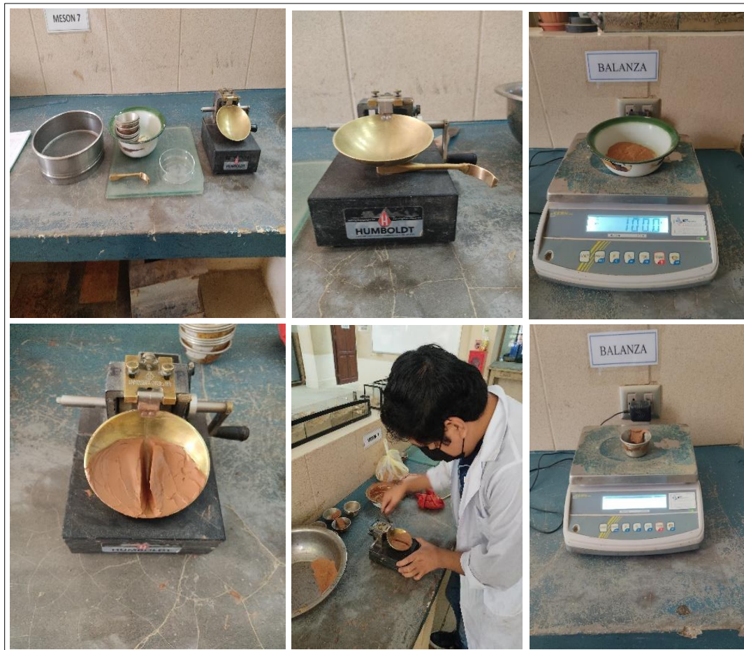
Figura 3.9 Proceso del límite líquido
