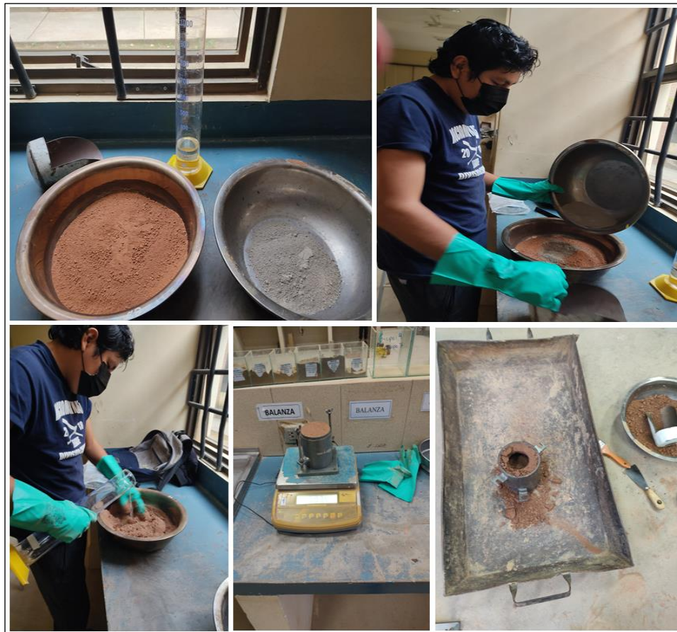
Figura 3.18 Proceso del ensayo compactación aplicando cemento
