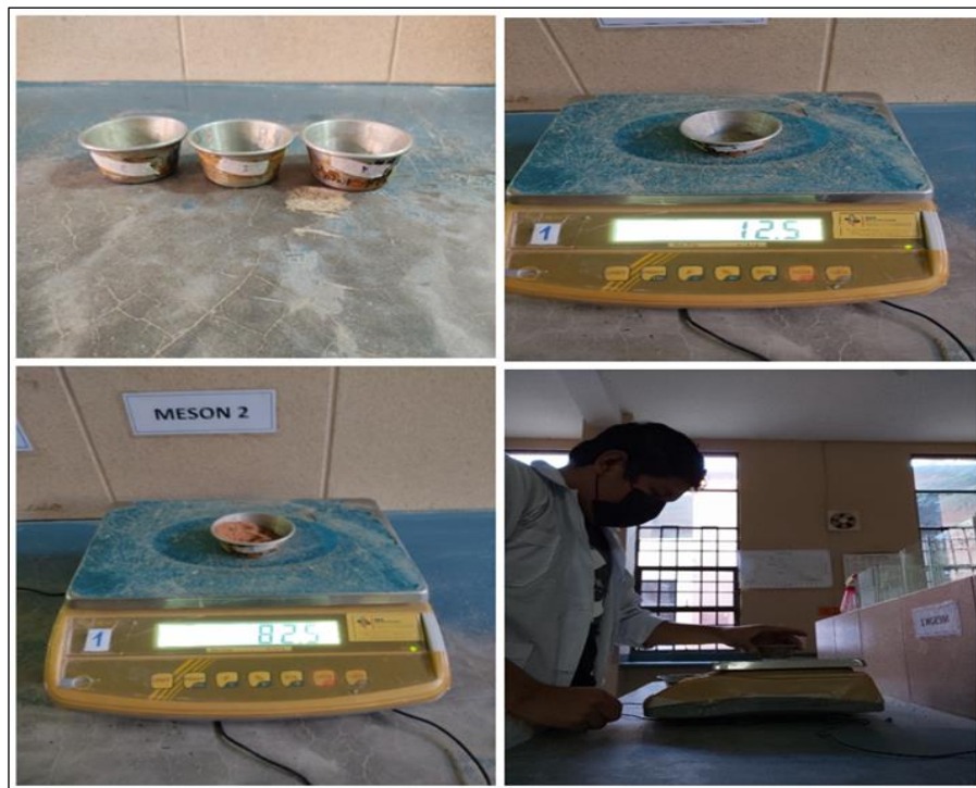
Figura 3.11 Proceso del ensayo contenido de humedad
