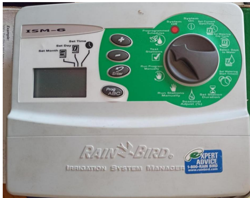
Figura 12. Controlador de electroválvulas. Fuente: Elaboración propia.
