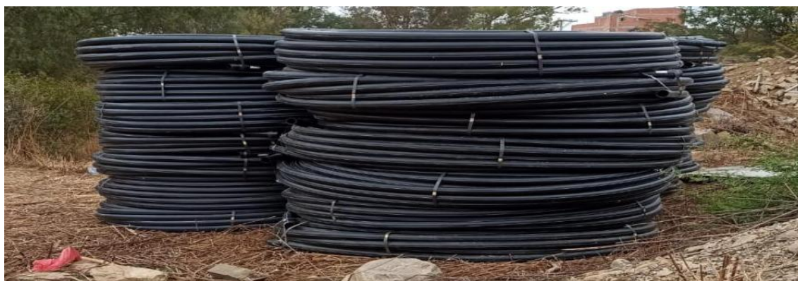
Figura 6. Rollos de tubería HDPE 63 mm.
