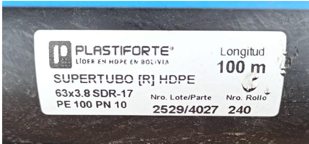
Figura 7. Especificación de cada rollo de tubería HDPE.
