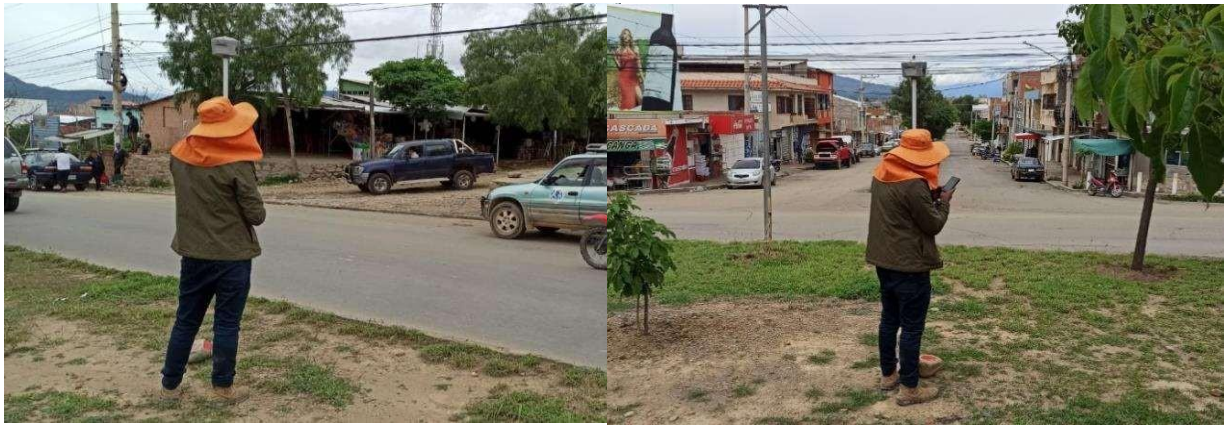
Ilustración 1. Lectura de coordenadas reales con RTK. Fuente: Elaboración propia.
