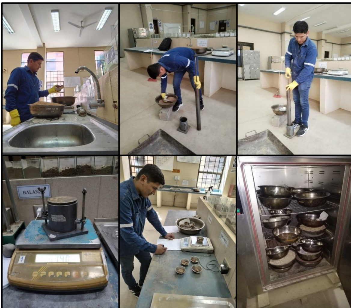
Figura 3.9: Proceso para realizar el ensayo de compactación
