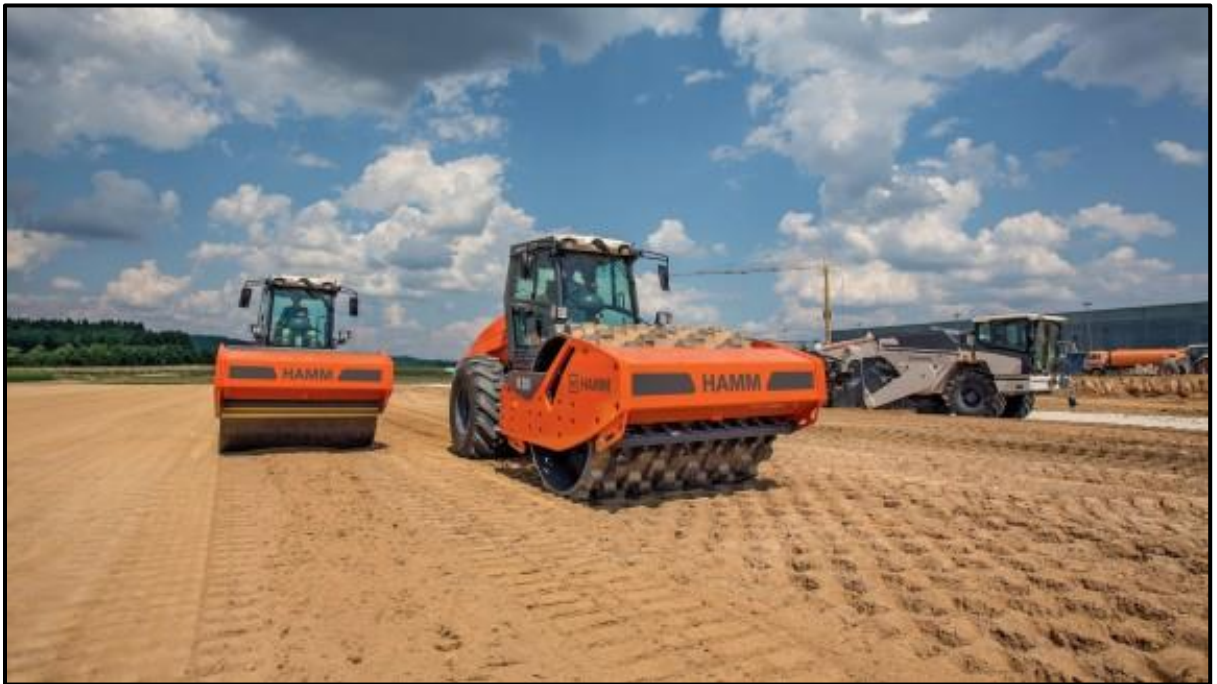
Figura 4.39: Compactadores rodillo liso y “pata de cabra”
