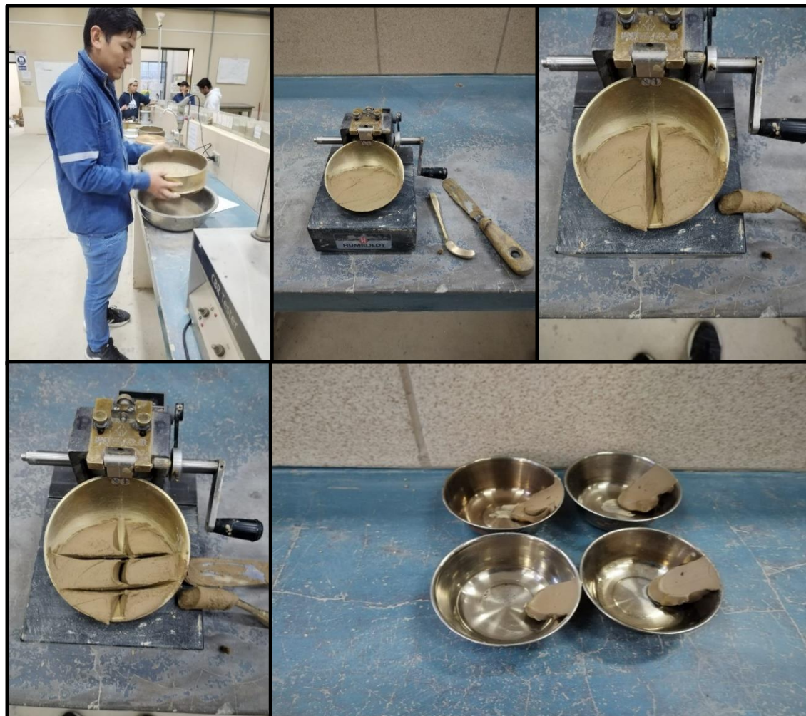
Figura 3.7: Proceso para determinar el límite líquido del suelo
