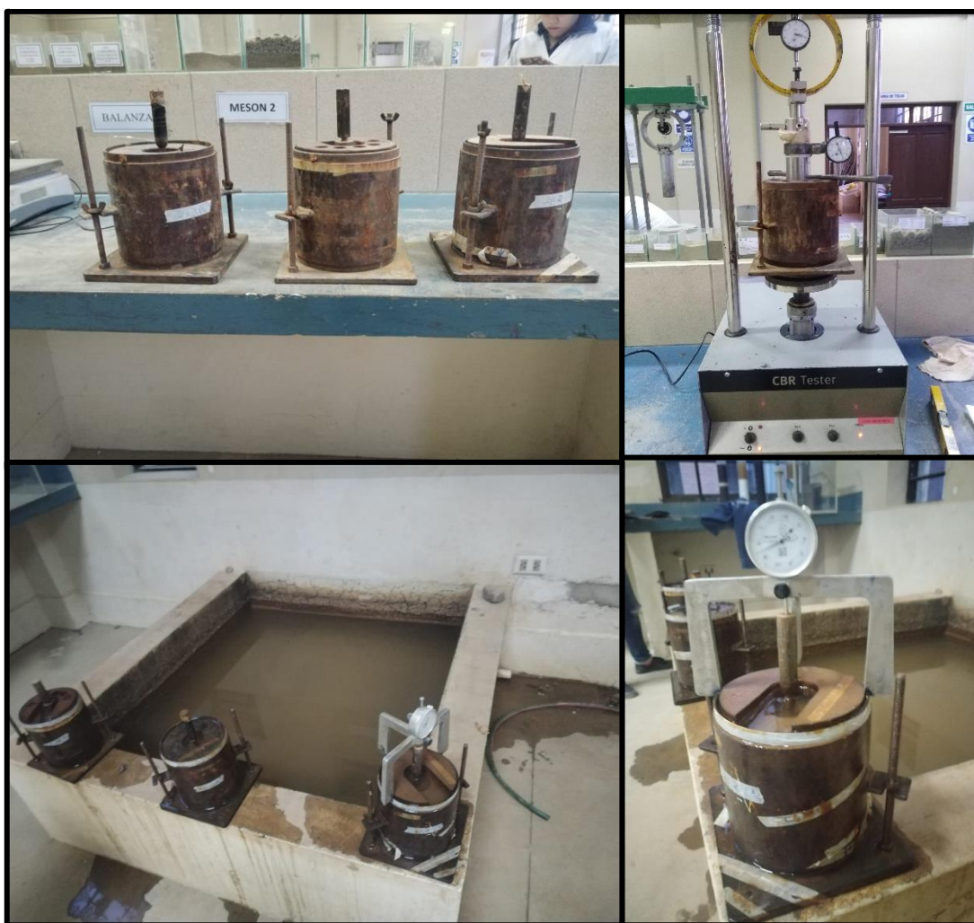
Figura 3.10: Proceso para realizar el ensayo de CBR
