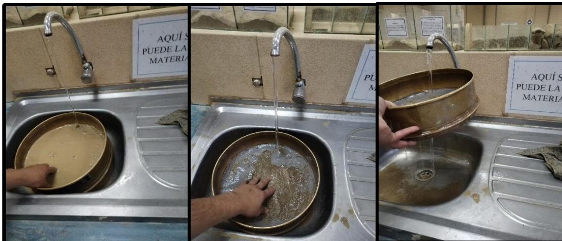
Figura 3.6: Proceso para la granulometría del suelo (método lavado)
