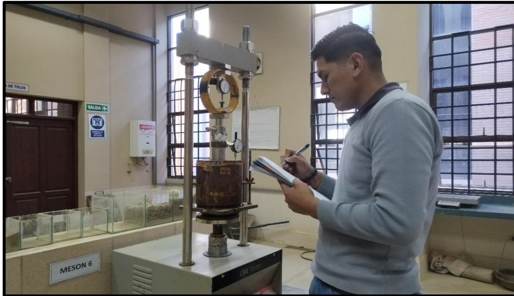
Figura 2.21: Ensayo de CBR realizado en laboratorio
