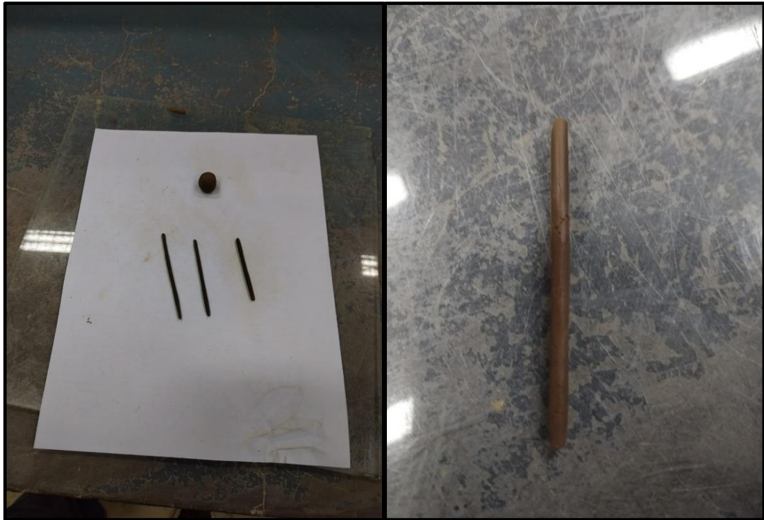
Figura 3.8: Proceso para determinar el límite plástico del suelo
