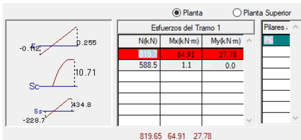
Figura 3.6 Esfuerzos de diseño de la columna P6 (Fuente: CYPECAD 2017)
