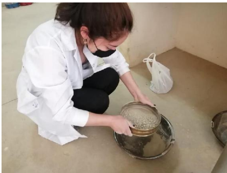
Figura 41 Realización de la granulometría de la muestra de suelo.
