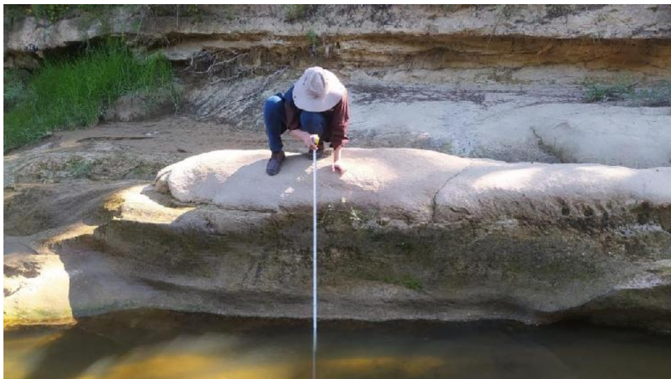
Figura 9 Medición de niveles normales y máximos del flujo de agua.
