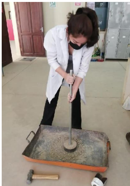
Figura 40 Eliminación de los terrones y materiales orgánicos.
