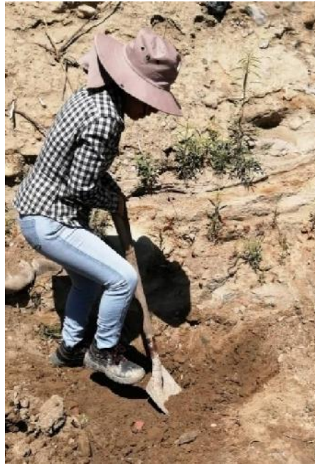
Figura 8 Excavación de calicatas para el muestreo de Suelos.
