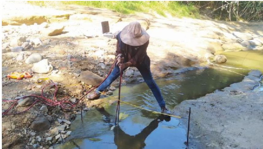
Figura 11 Aforo de caudal quebrada “El Monte”.
