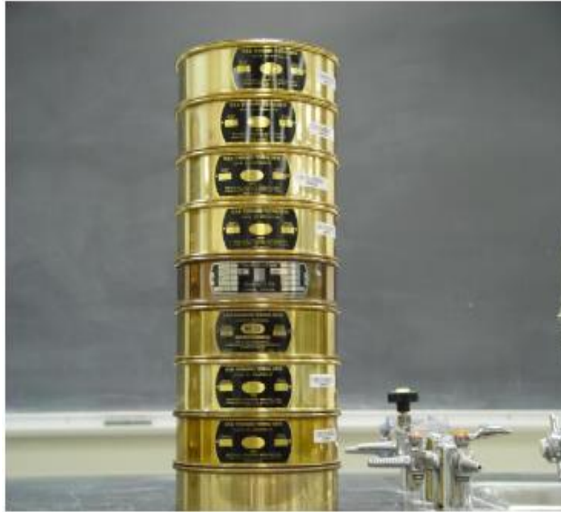
Figura 15. Tamices superpuestos juego de mallas
