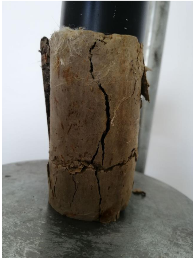
Figura 10. Falla en una muestra de prueba de compresión no confinada
