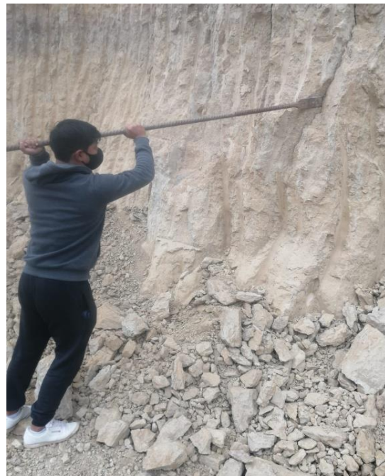
Figura 19. Extracción de la muestra
