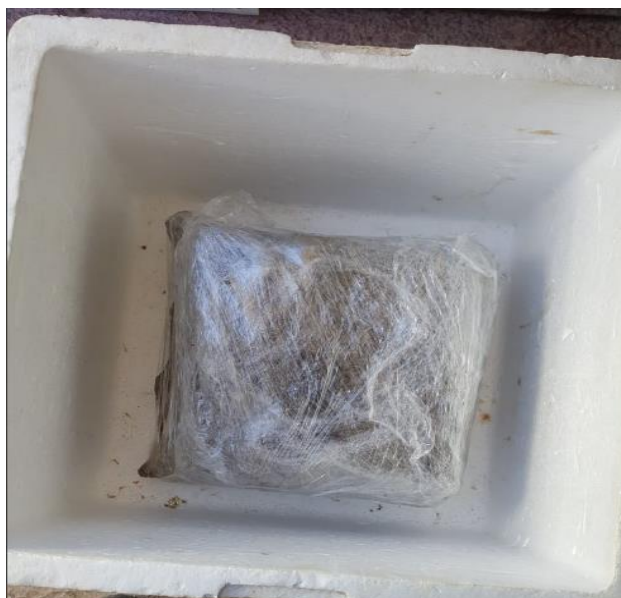
Figura 22. Muestra Conservadora para que mantenga su contenido de humedad
