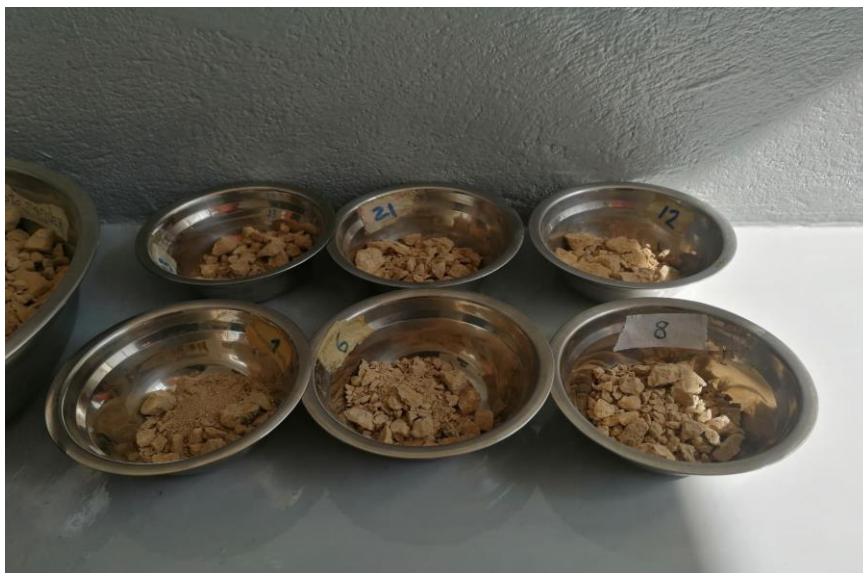
Figura 23. Ensayo de contenido de humedad
