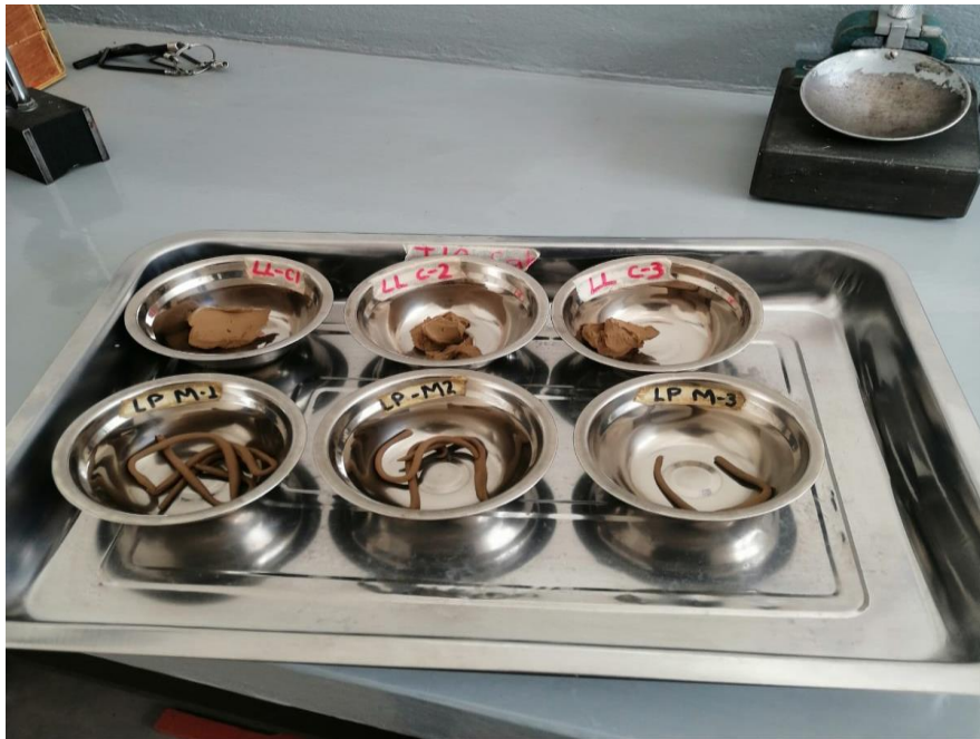
Figura 27. Ensayos de límites líquidos y límites plásticos
