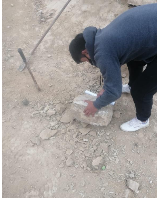
Figura 20. Envolviendo la muestra con papel feel
