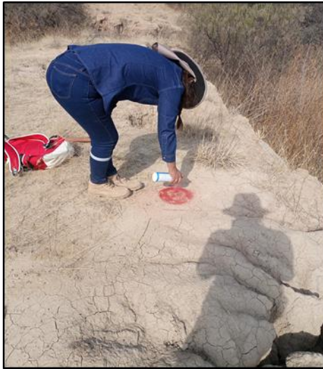
Foto N° 3 Marcado puntos de control
