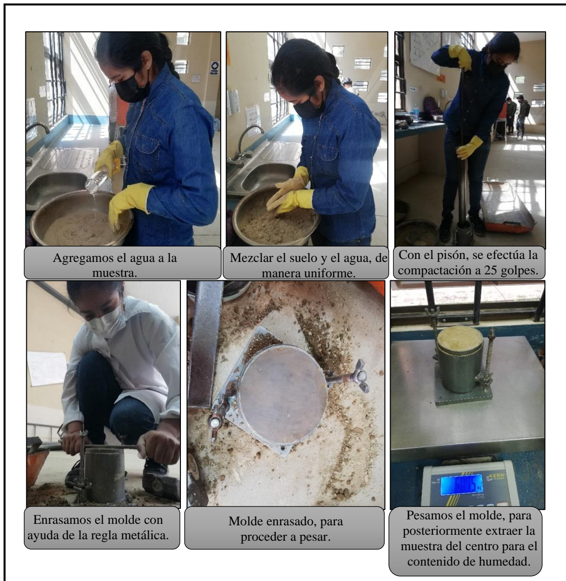
Figura 3.8 Ensayo de compactación T-99
