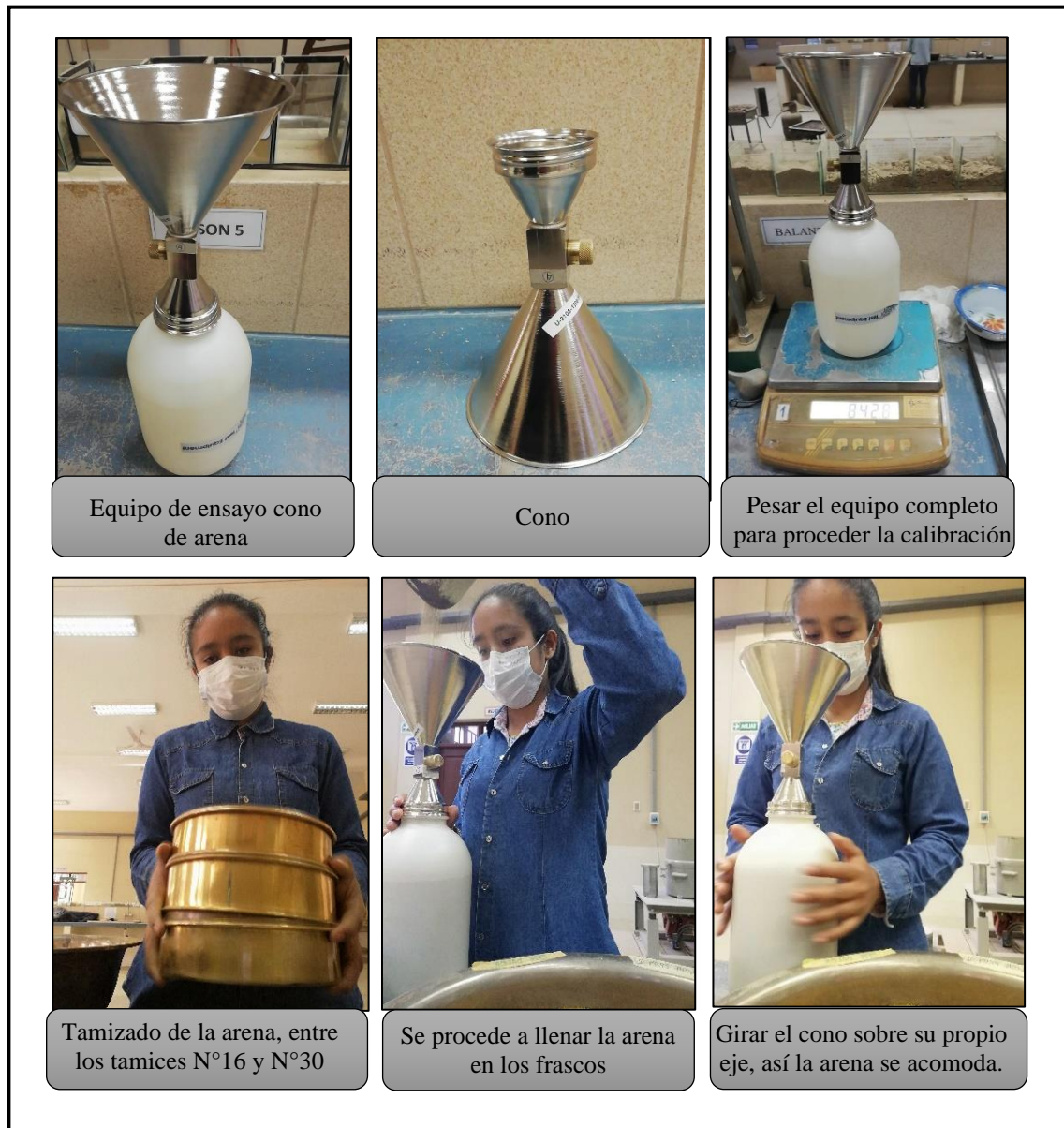
Figura 3.9 Ensayo cono de arena
