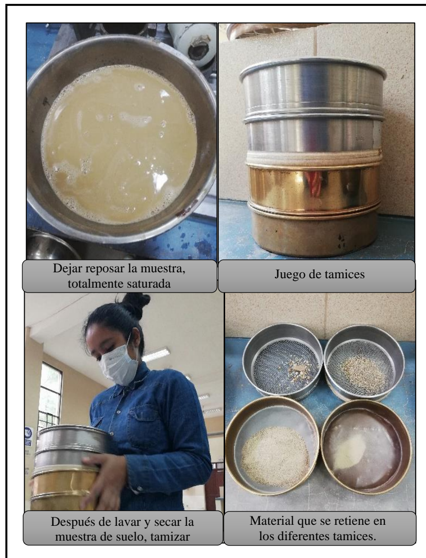
Figura 3.5 Ensayo granulométrico por método del lavado
