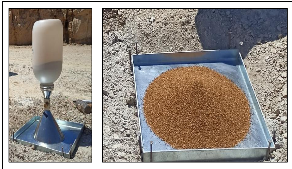
Figura 2.11 Equipo cono de arena – arena del Saire
