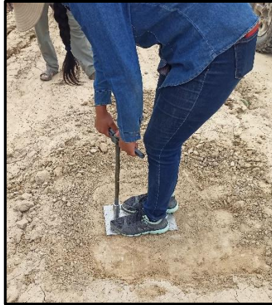
Figura 2.18 Varilla de perforación
