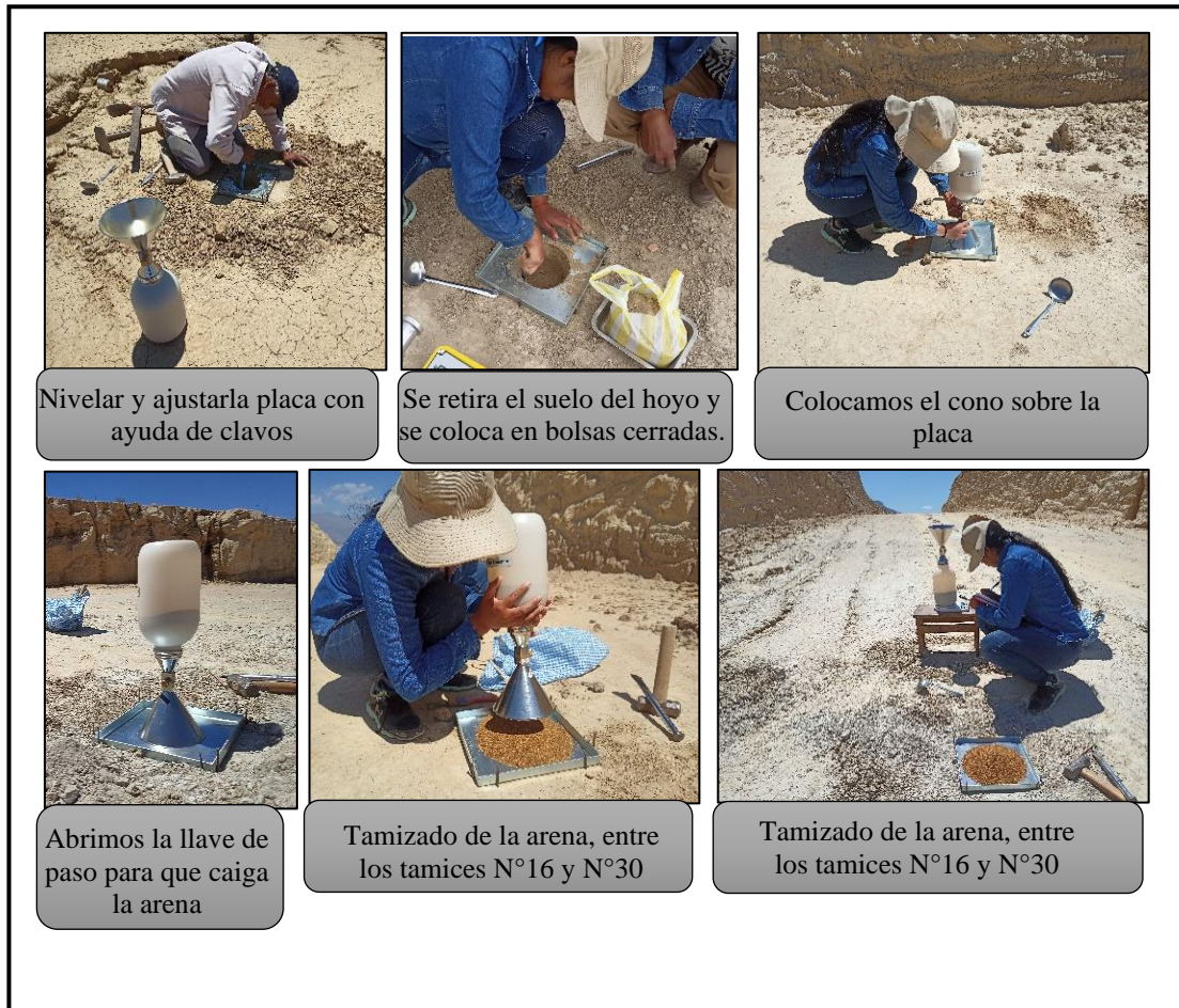
Figura 3.10 Ensayo cono de arena
