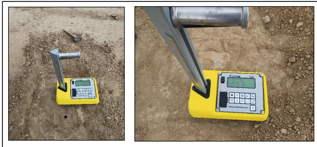
Figura 2.13 Equipo densímetro nuclear
