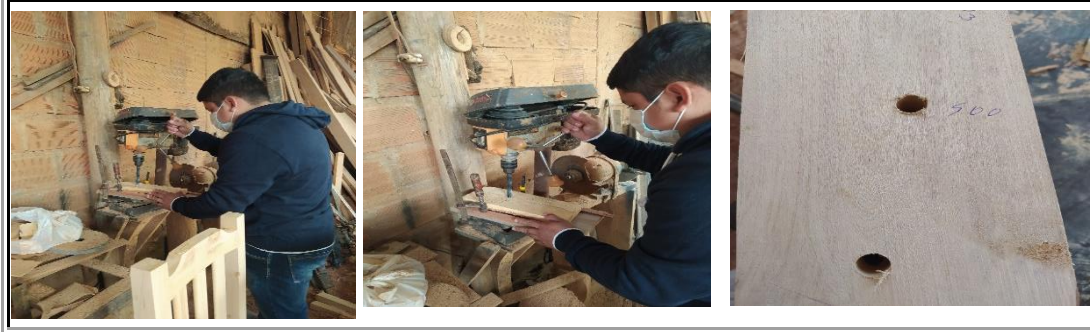
IMAGEN N° 33: BROCA PARA ENSAYO DE TALADRADO
