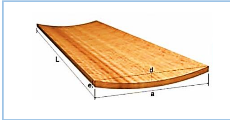
FIGURA N° 7: ABARQUILLADO DE LA MADERA
