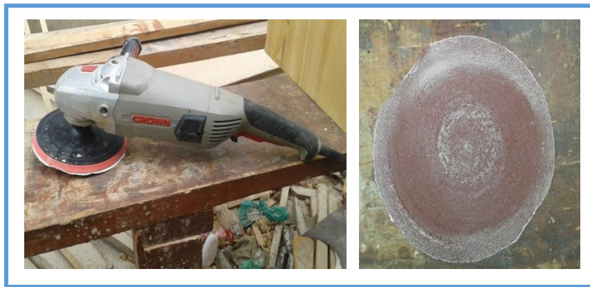
FIGURA N° 37: ENSAYO DE LIJADO
