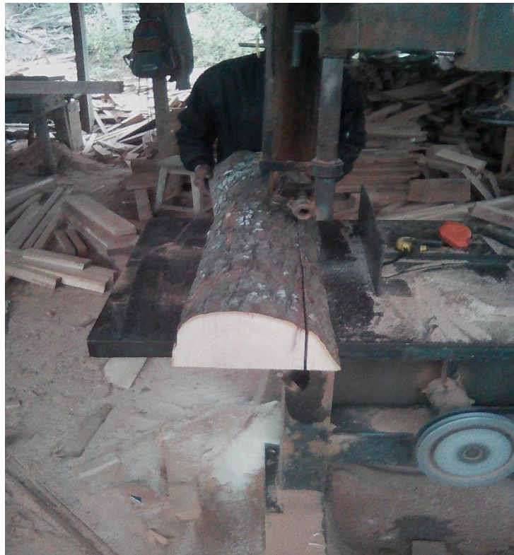
Fotografía N° 4 Proceso de aserrío para la obtención de las probetas.
