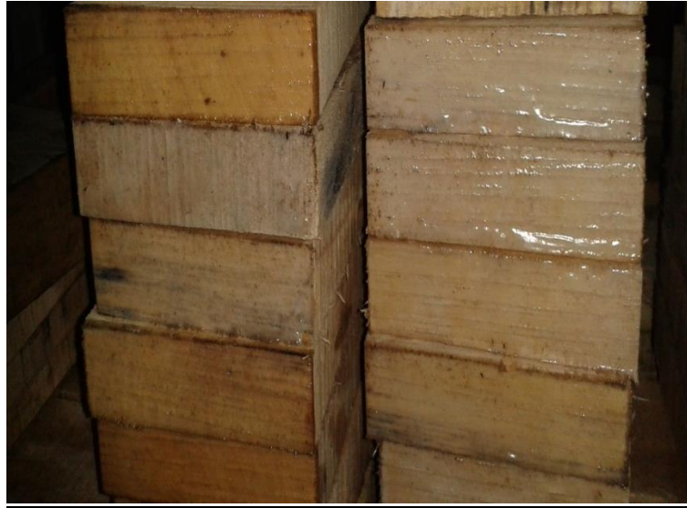
Fotografía N° 5 Parafinado de probetas.
