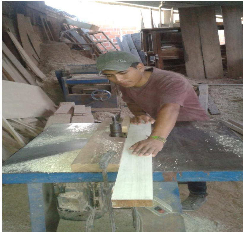
Fotografía N° 10 Ensayo de moldurado.
