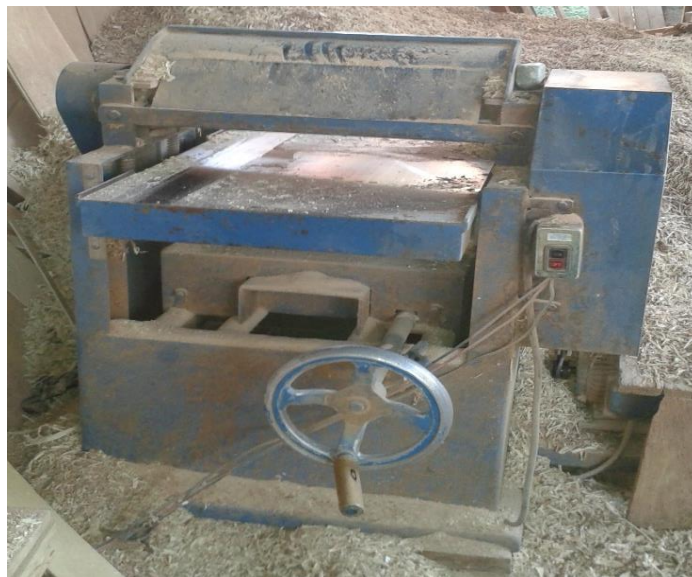
Fotografía N° 8 Ensayo de cepillado (grueseadora).
