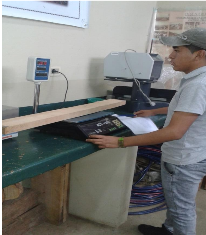
Fotografía N° 7 Control de contenido de humedad.
