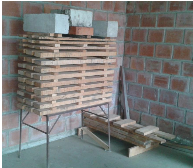
Fotografía N° 6 Proceso de secado al aire libre.
