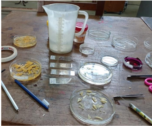
Foto N° 16: Coloración de las láminas de los diferentes cortes (radial, trasversal y tangencial)
