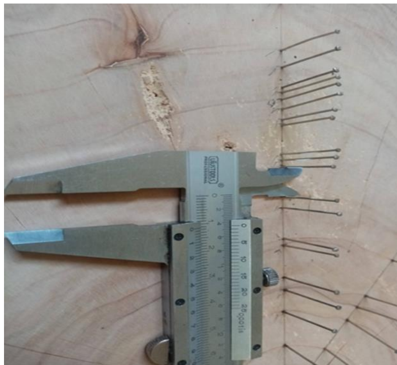
Medición de los anillos de crecimiento con el vernier
