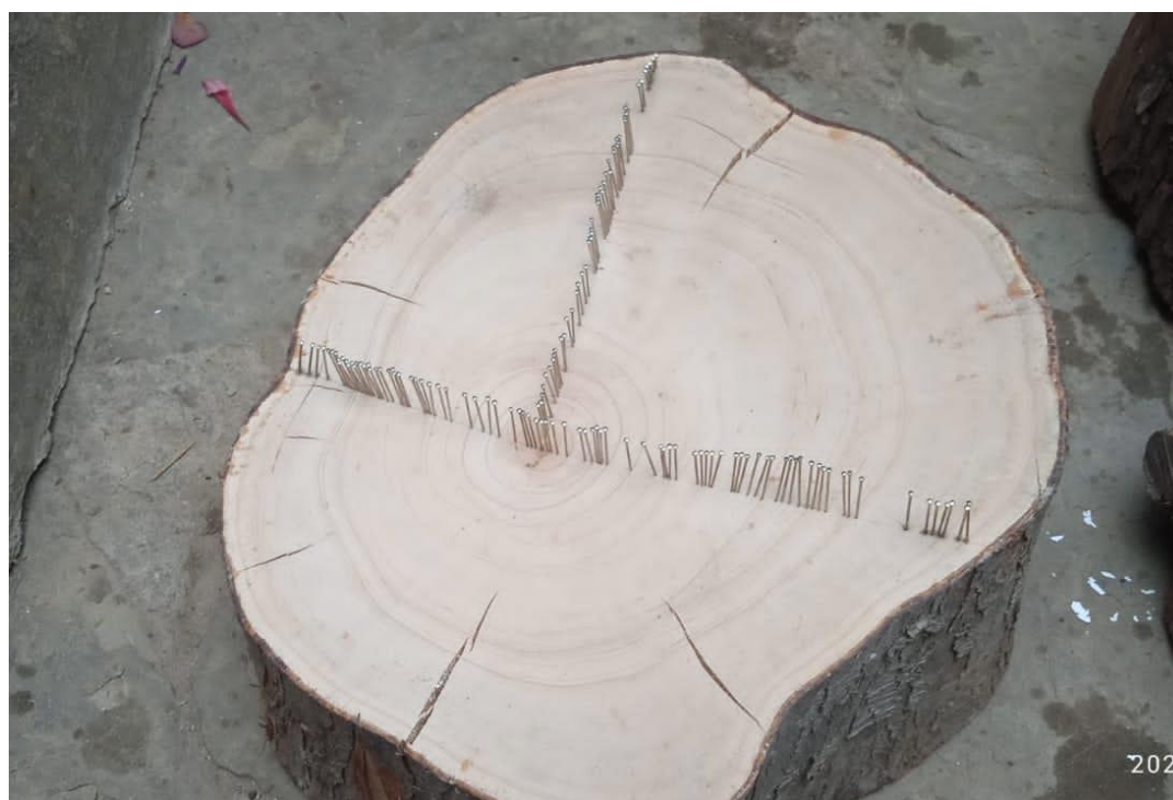
Fijación de los alfileres sobre la muestra de Cupressus macrocarpa
