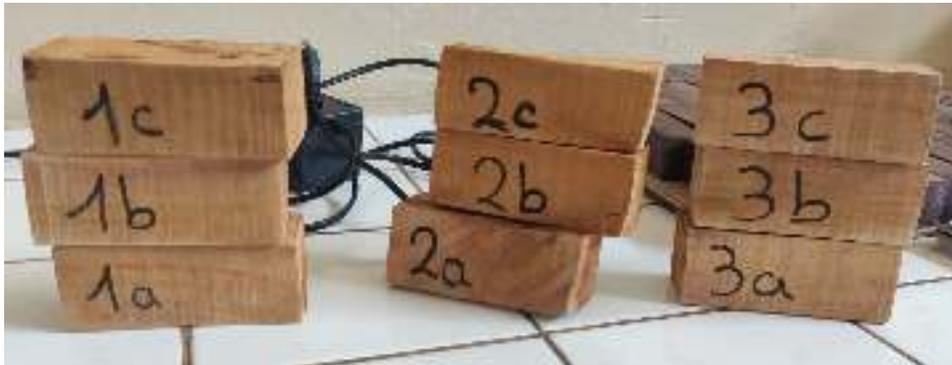
Anexo N°6. Probetas para la determinación del contenido de humedad.
