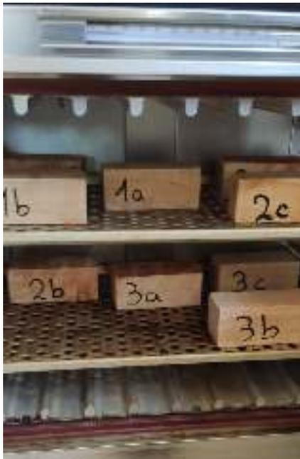
Anexo N°7. Introducción de probeta a la estufa
