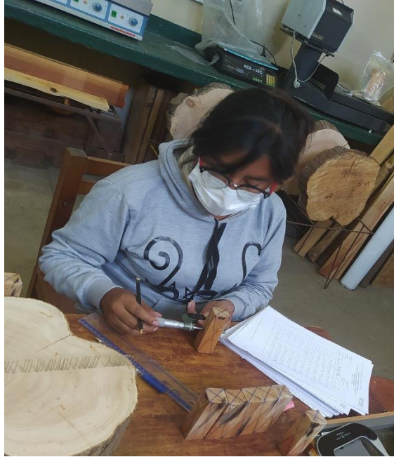
Medición de probetas en sus diferentes dimensiones
