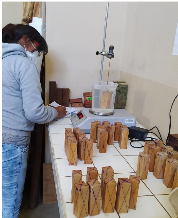
Pesado de probetas para sacar el volumen por método de inmersión
