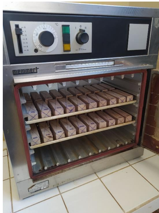
Probetas puestas en estufa a 103 °C
