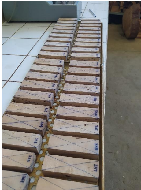
Preparado de probetas para ser puestas en estufa
