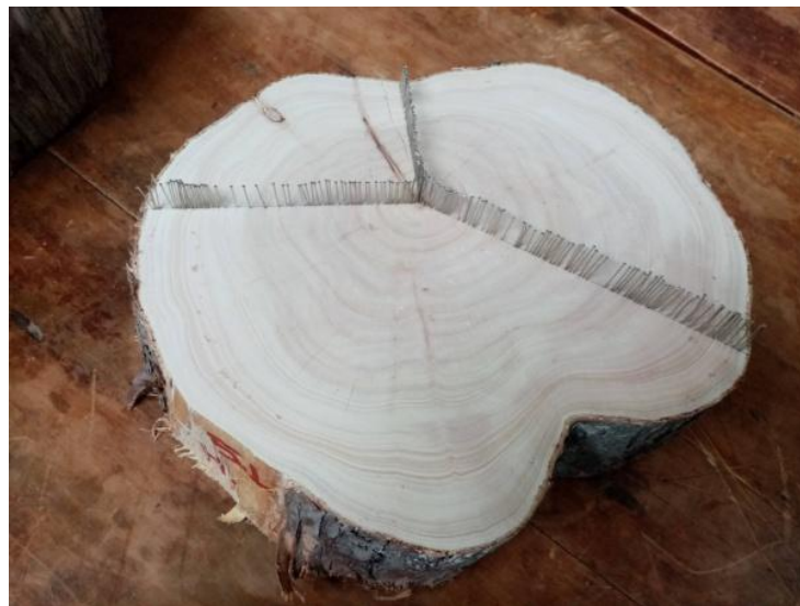
Fijación de los alfileres sobre la muestra de Cupressus macrocarpa Hartw. Ex Gordon.
