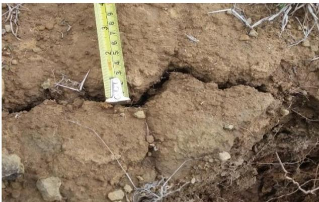
Foto 15. El proceso que da lugar a la formación de surcos es el colapso mecánico originado por el lavado y socavamiento del agua de escurrimiento que desgasta el talud hasta que un bloque queda fuera del centro y gravedad, se agrieta y colapsa, por este proceso el surco crece en forma longitudinal y lateral
