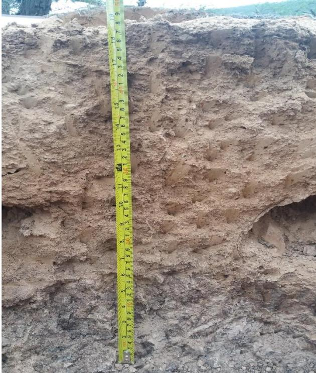
Foto 19. En el perfil del suelo se verifica que el segundo horizonte se presenta con un grado de cementación moderada y el cuarto presenta cementación fuerte y continua característica que influye en el proceso de infiltración del agua al suelo y formación de la cárcava.
