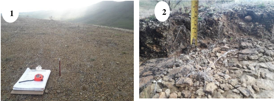
Fig. 1 Erosión laminar con suelos desnudos sin vegetación con abundante grava Fig. 2 suelos con mucha pedregosidad con una pérdida de 8 cm de profundidad por el transporte de suelo y desprendidos por las lluvias
