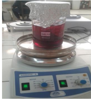
Figura III-8: Extracción con solvente en agitador magnético
