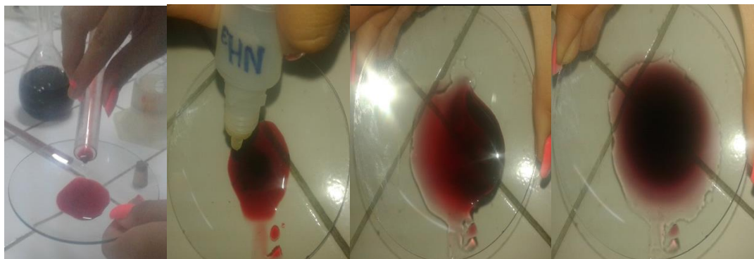
Figura III-26: Prueba cualitativa para presencia de Betalaínas con NH_3
