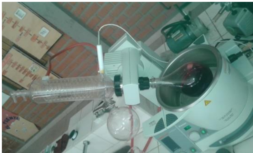
Figura III-16: Evaporación y concentración del colorante en rota-vapor
