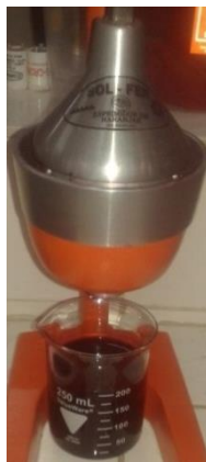
Figura III-22: Compresión de la parte sólida separada en la filtración
