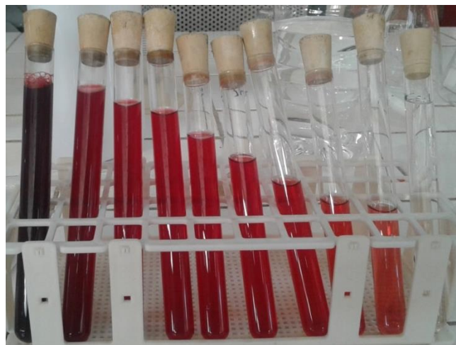
Figura III-18: Solución madre e hijas para la elaboración de la curva espectrofotométrica
