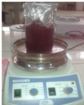
Figura III-13: Extracción con solvente en agitador magnético
