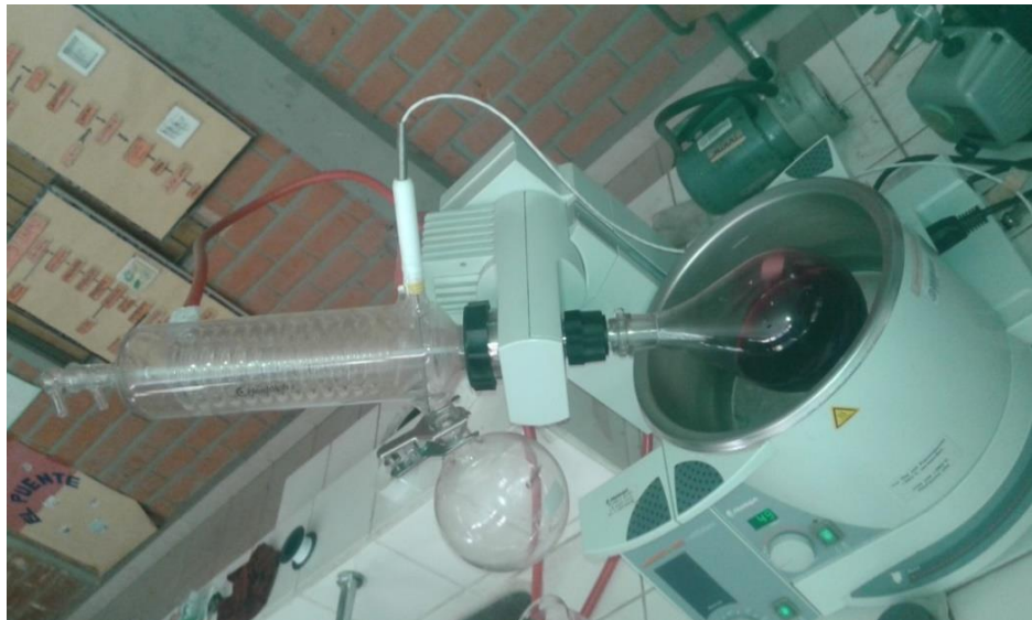
Concentración de colorante y recuperación de alcohol étílico en Rota-evaporador
