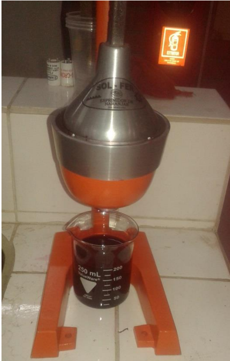
Extracción de parte líquida en filtro-prensa
