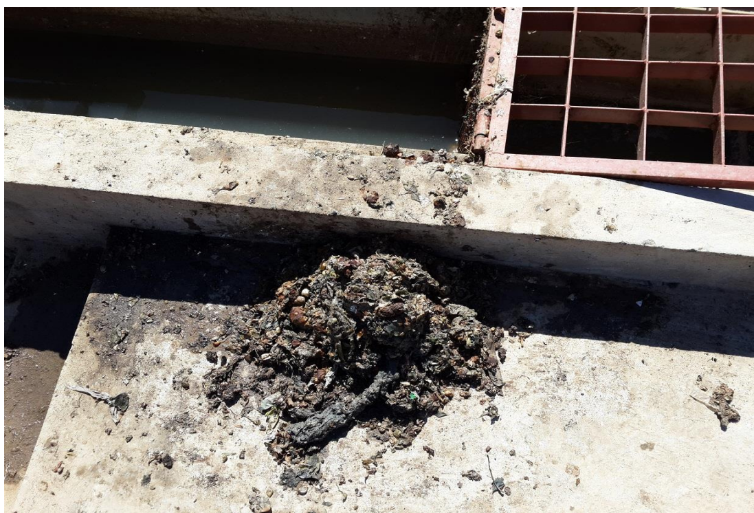
Figura 4-2 Semisólidos provenientes del tanque sedimentador
