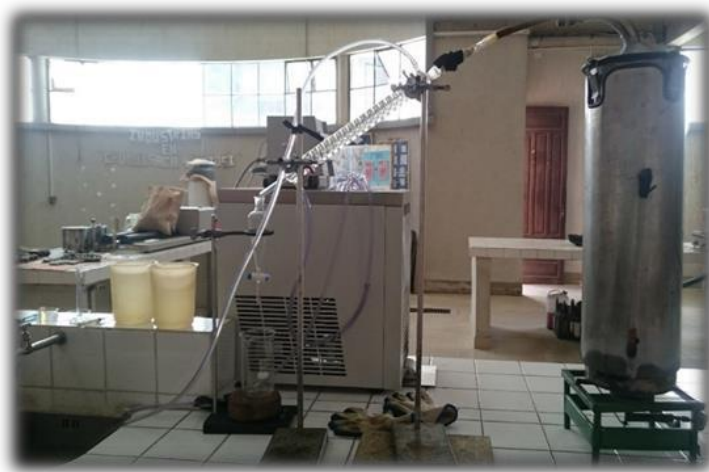
Figura I-6: Equipo de Destilación por arrastre de vapor.
