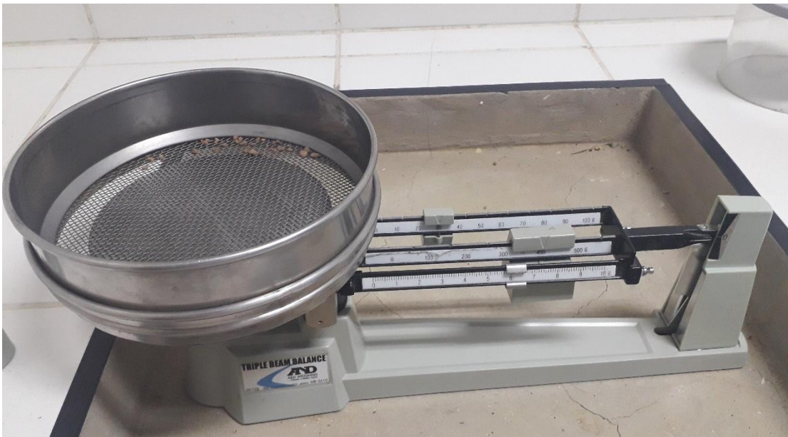
Foto F-11 Pesaje de los rechazos en cada malla para realizar el análisis granulométrico
