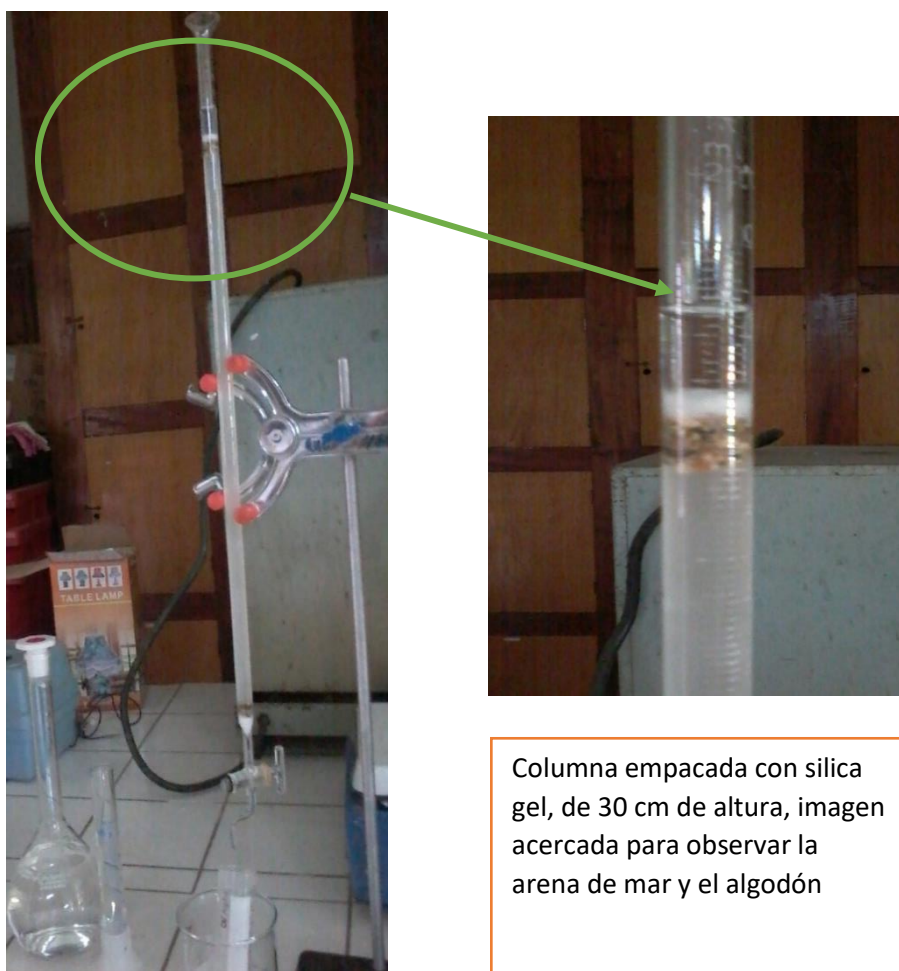
Figura 3-11 Columna empacada con silica gel
