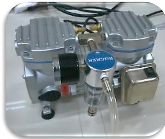
Fotografía N° 3-6: Bomba de vacío
