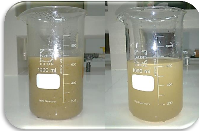
Fotografía N° 3-18: Solución hidrolizada antes y después del filtrado
