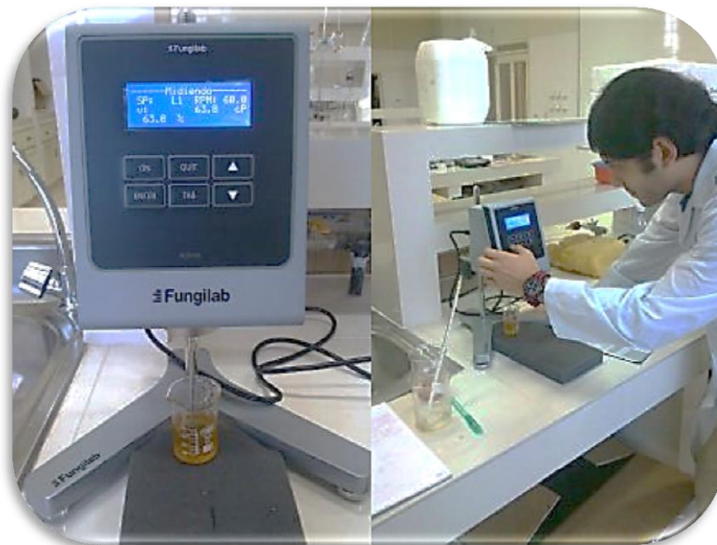
Fotografía N° 4-2: Medición de la viscosidad de los geles de pectina
