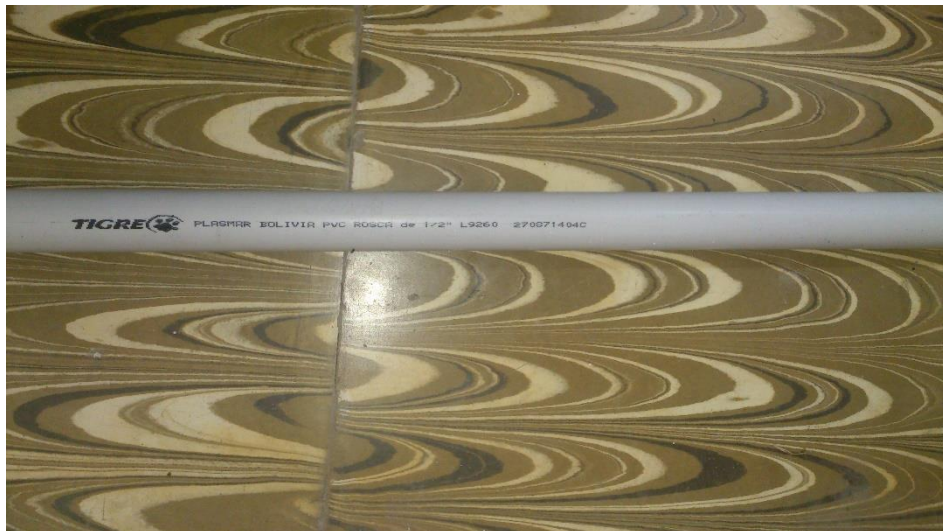
Figura ¡Error! No hay texto con el estilo especificado en el documento. -20 Tubería de PVC de 1/2 in.
