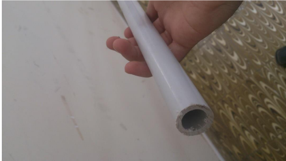
Figura ¡Error! No hay texto con el estilo especificado en el documento. -19 Tubería de PVC de 1 in.
