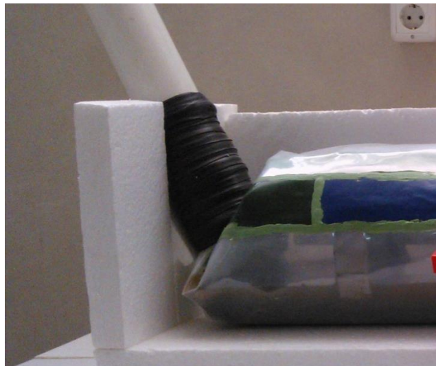
Figura ¡Error! No hay texto con el estilo especificado en el documento. -34 Primera carga, sellado de agua de la tubería de entrada.
