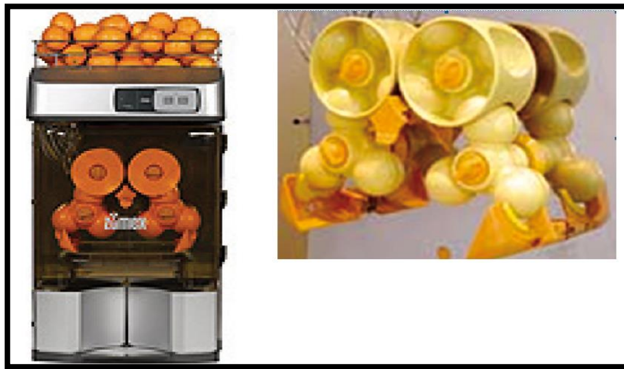
Figura 1-3 ESQUEMA DE UNA MÁQUINA EXTRACTORA DE ZUMOS ZUMEX
