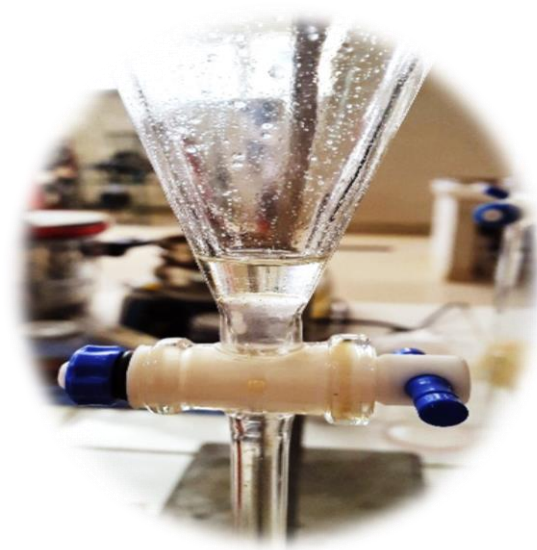
Foto 2. 13. Separación de aceite esencial y agua
