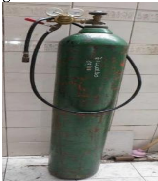
Figura 3-9: Botellón de Nitrógeno.
