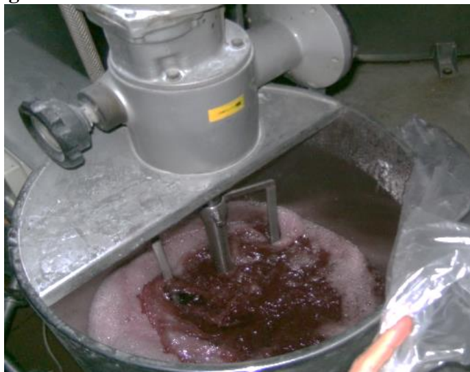
Figura 2-3: Vino en contacto con el aire en el Filtro de Tierras.
