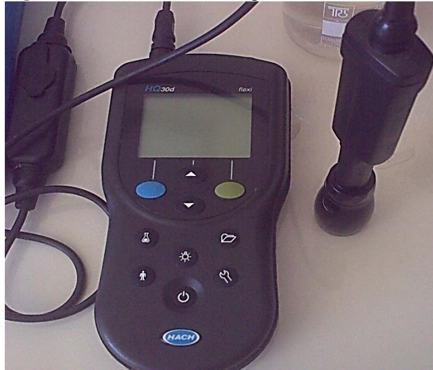
Figura 2-1: Medidor de oxígeno HACH HQD con sonda LDO.
