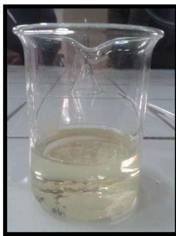
Figura 2-13 Secado del aceite esencial de cáscara de naranja
