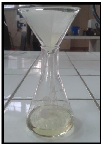
Figura 2-14 Filtrado del aceite esencial de cáscara de naranja
