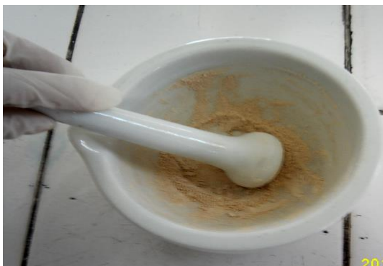
Figura 2-21: Molienda de la proteína aislada
