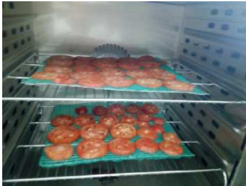
Estufa cargada para el deshidratado de tomate fresco
