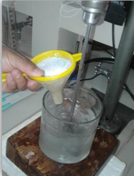
Figura II – 14: TAMIZADO DE CARBOPOL
