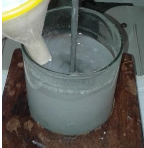
Figura II – 15: MEZCLA 1, SOLUCIÓN ALCOHÓLICA Y POLÍMERO
