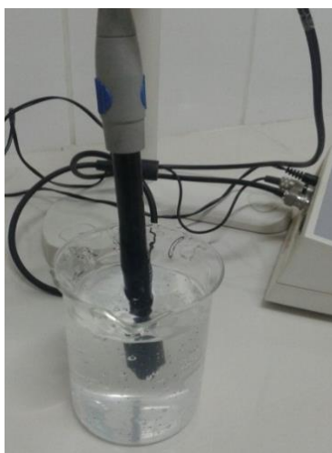
Figura II – 19: MEDICIÓN DE pH.
