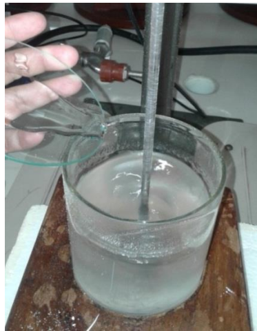
Figura II – 17: AGREGACIÓN DE TRIETANOLAMINA
