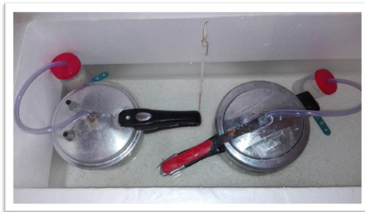
Fotografía III-15 TANQUES DE FERMENTACIÓN EN EL SISTEMA DE FRIO
