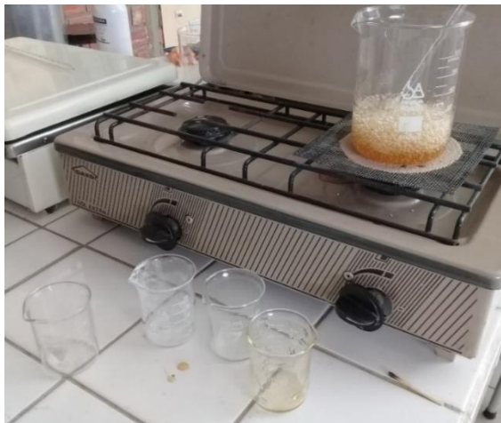
Figura II-7: DISOLUCIÓN CON AGITACIÓN, POR CALENTAMIENTO
