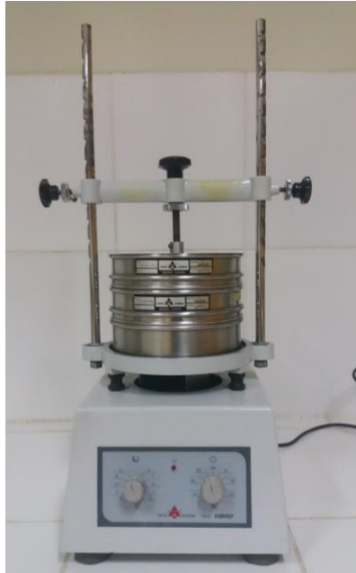
Figura 2-6 Proceso de tamizado
