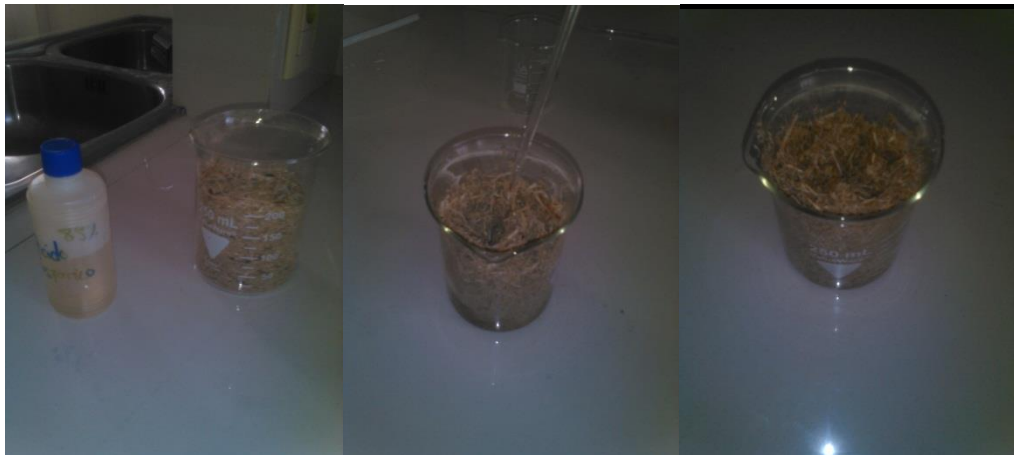
Impregnación del ácido diluido con el bagazo de caña de azúcar.
