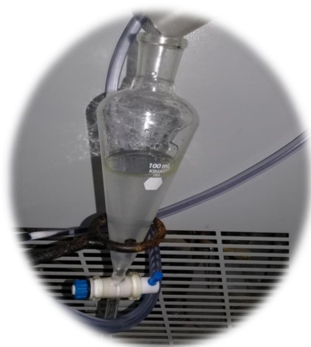
Figura II- 9 Condensado de mezcla de agua y aceite esencial.
