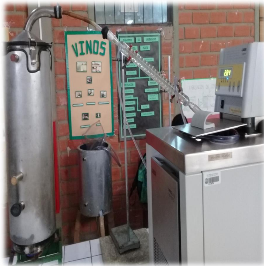
Figura II- 6 Equipo armado y completo para la extracción de aceite esencial de cedrón.
