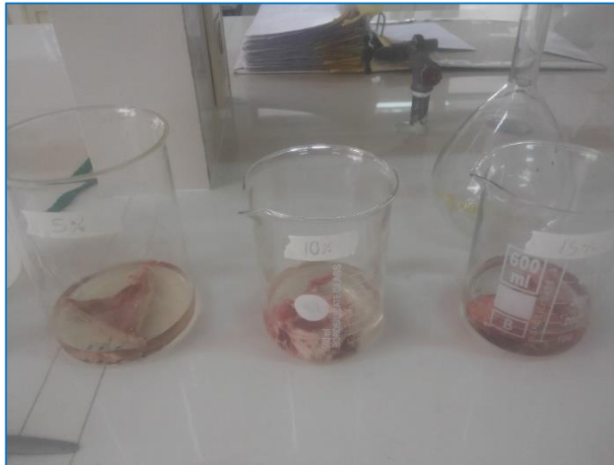
Foto 2.1. Descarne con Soda Caustica
