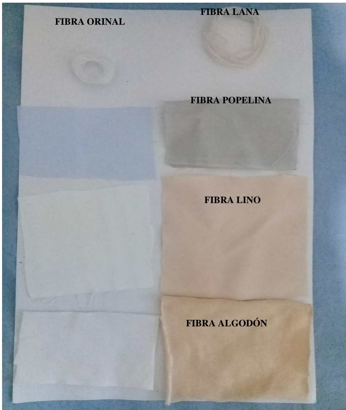
Figura 12 Primera prueba de tinción con sulfato de cobre penta hidratado con 100 ml de colorante al 5 % de concentración
