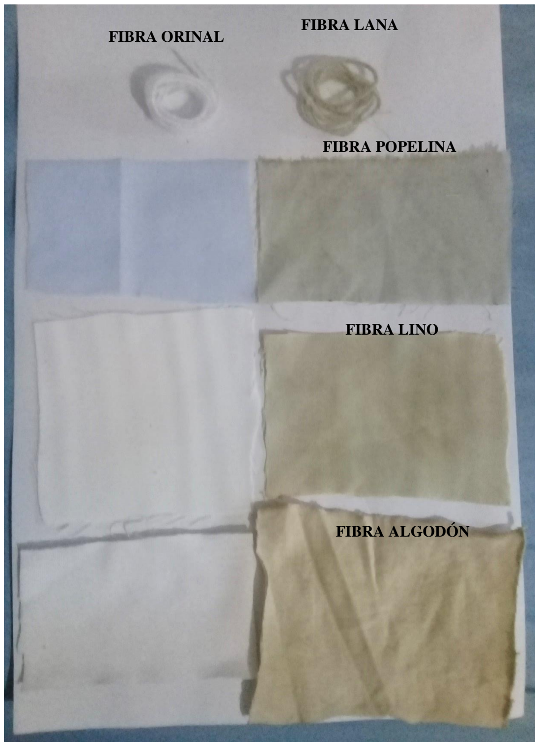
Figuras 18. Primera prueba de tinción con sulfato de ferroso con 100 ml de colorante al 5 % de concentración
