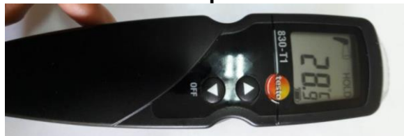
Figura 3.7 Termómetro pistola laser
