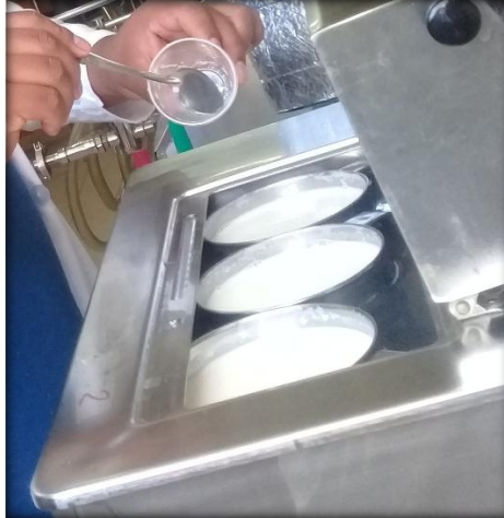
Figura 3.9 Inoculación de la mezcla con cultivo lácteo
