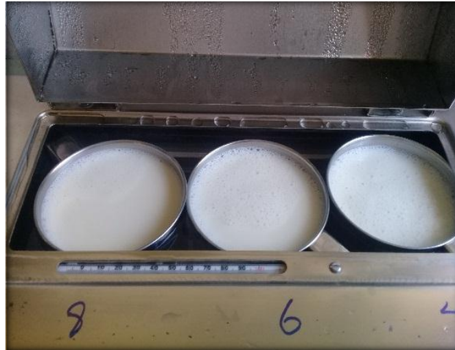
Figura 3.8 Pasteurización de la mezcla con los insumos
