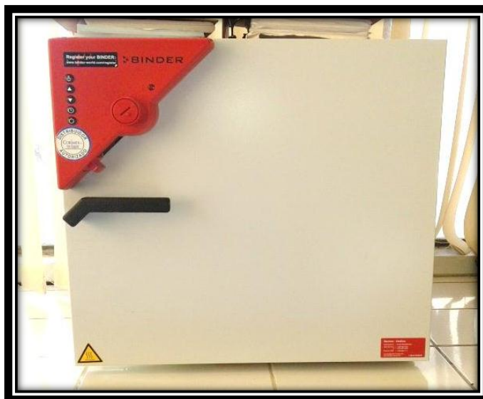
Figura 3.2 Estufa de laboratorio
