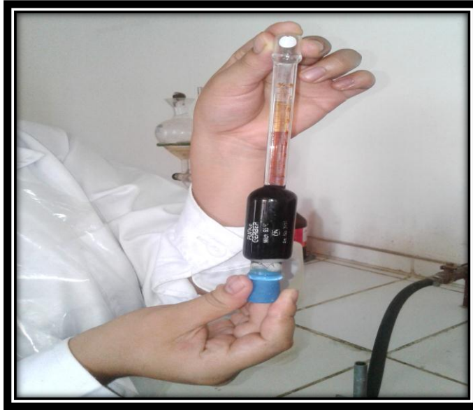
Figura 3.11 Determinación de materia grasa de la leche en polvo reconstituida por el método Gerber
