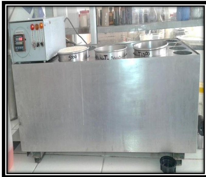
Figura 3.5 Termostato (Baño maría)
