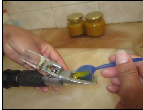
Medición de °Brix en refractómetro
