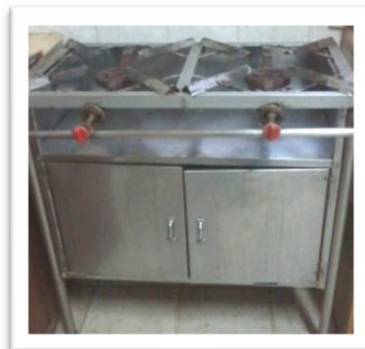
Figura 3.8 Cocina industrial de dos hornallas
