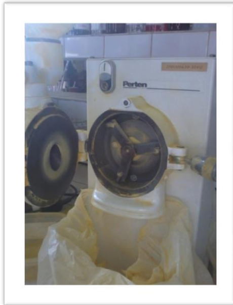
Figura 3.21 Molienda de las muestras de zapallo deshidratadas para obtener harina
