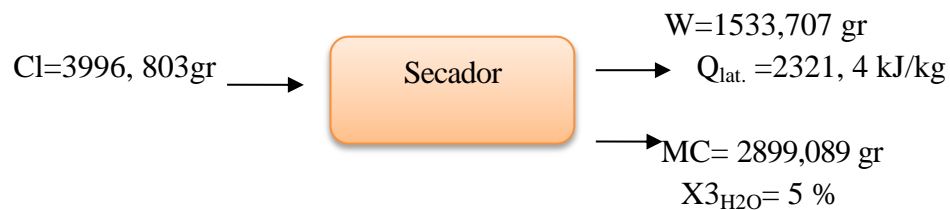
Fig. 4.17 Diagrama de bloques para el balance de energía en la etapa del malteado
