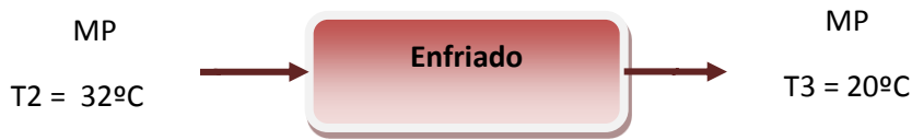
Figura 4.16: Etapa de enfriamiento del mosto en fermentación alcohólica
